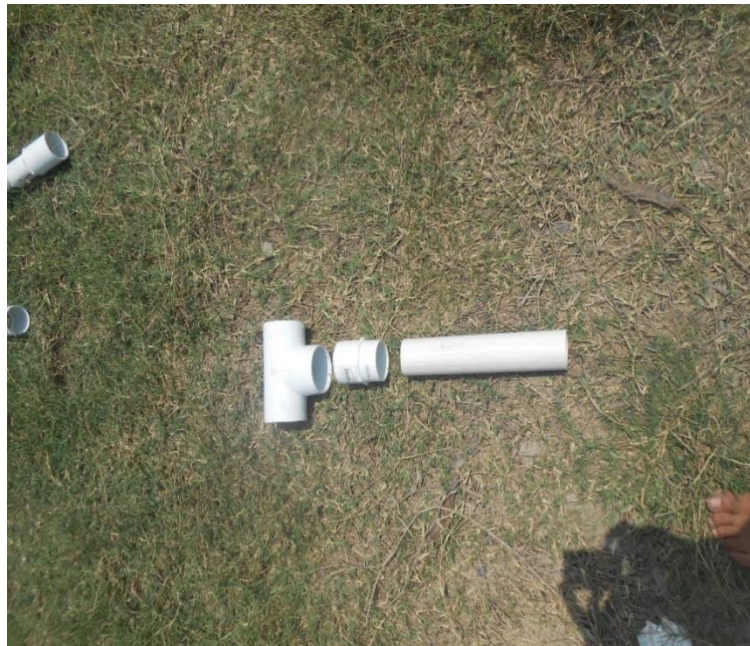
Figura A – 8. Modificación de acople en Venturi.
