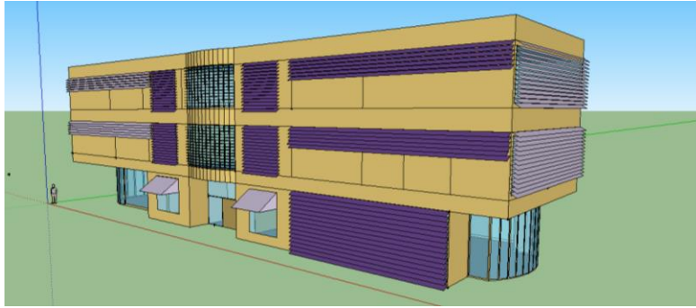
Figura 33. Modelado en software de los cortasoles en el edificio de Administración Académica de la FIA.
