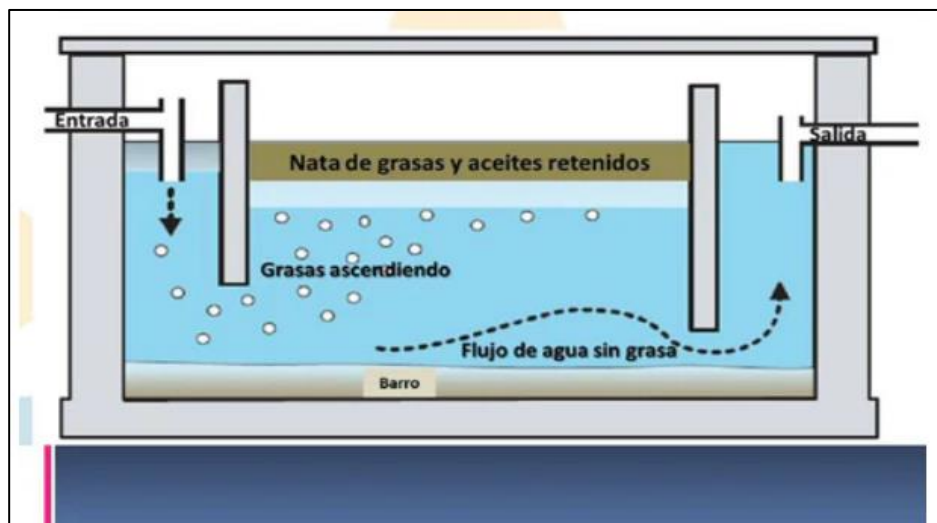
Figura 2.8 Esquema de funcionamiento de una trampa de grasas
