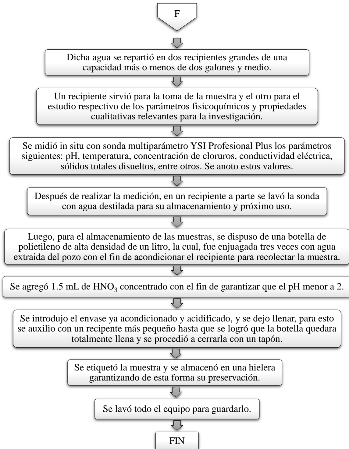
Figura A. 3. Flujograma de procedimiento realizado en la recolección de muestras para la matriz de agua subterránea. Fuente: Elaboración propia utilizando como base la Guía Operativa para la Recogida, Almacenamiento y Transporte de Muestras de Aguas Subterráneas Destinadas al Análisis Químico.
