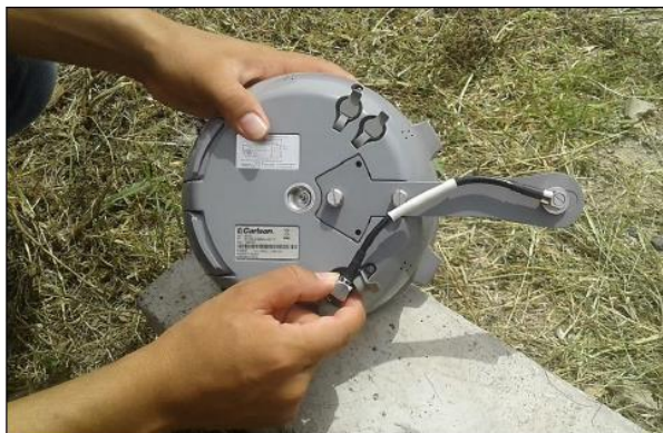
Figura 79. Enroscado de cable de antena a equipo.
