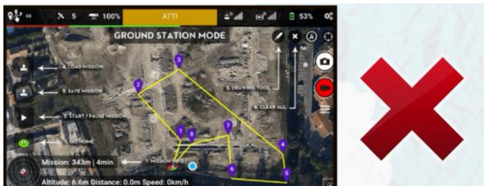
Figura 29. Ejemplo error por planificación de vuelo deficiente
