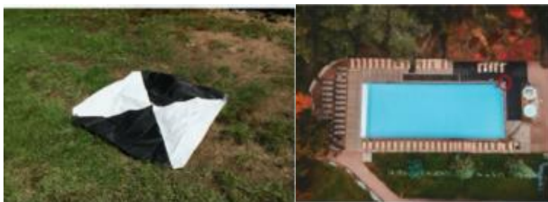
Figura 26. Identificación de los puntos de control terrestre
