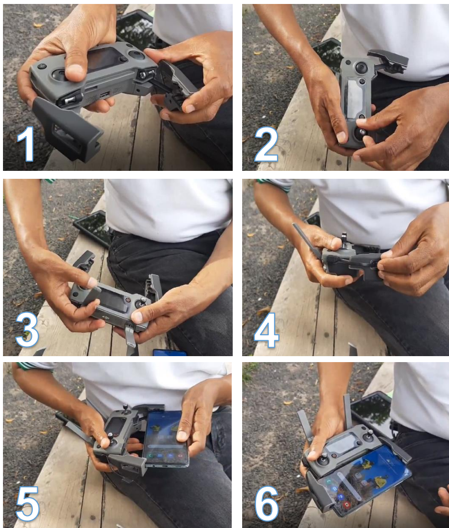
Figura 106. Paso a paso de armado de control remoto del dron y conexión del smartphone.
