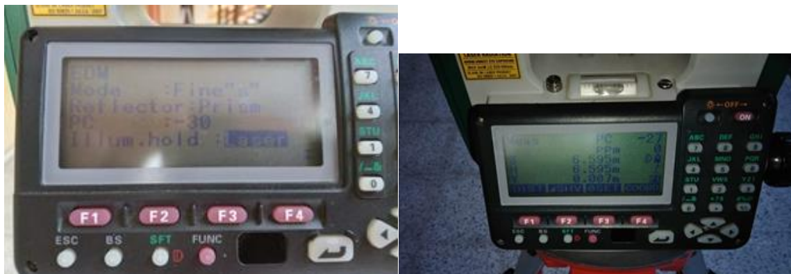
Figura 36. Calibración de constante de prisma en estación total
