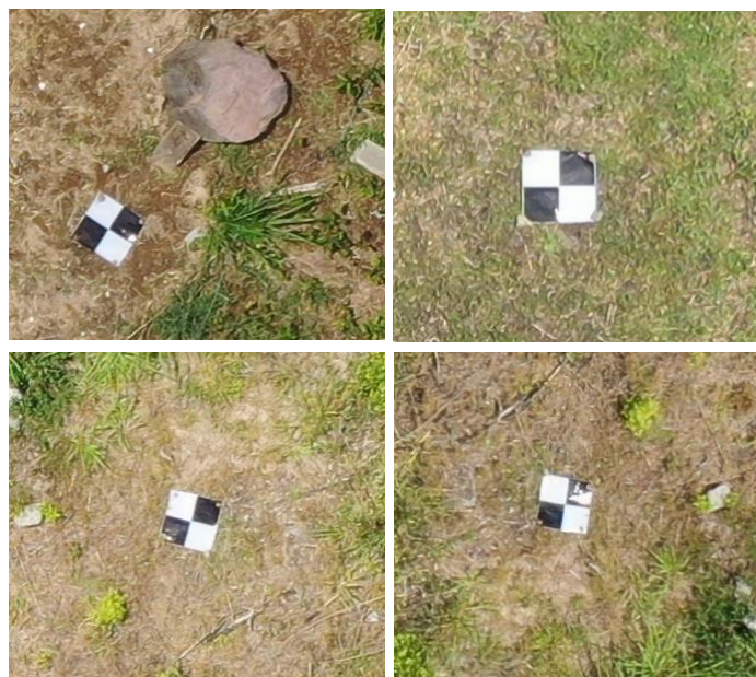
Figura 109. Lonas para puntos de control fotogramétrico colocadas en el terreno. (Fuente: Creación propia)
