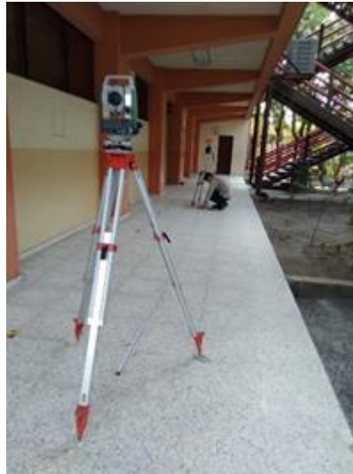
Figura 35. Calibración de constante de prisma en estación total
