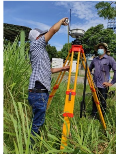
Figura 94. Medición de altura de antena. (Fuente: Tesis “Análisis comparativo de modelos digitales de terreno obtenidos con técnicas satelitales GNSS y estación total”, noviembre 2021)
