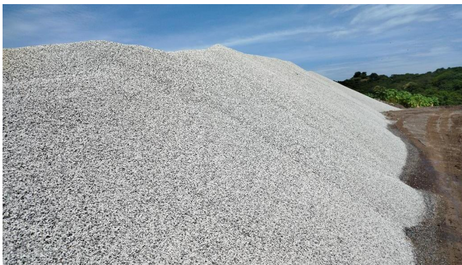
Figura 11. Acopio de Material Triturado para ser Reutilizado
