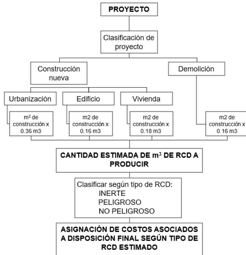
Figura 24. Esquema de estimación de costos asociados al plan de gestión de RCD
