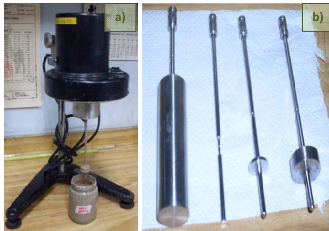
Ilustración 4.26 Determinación de viscosidad en diatomita: a) viscosímetro de Brookfield; b) tipos de agujas o spindle del viscosímetro
