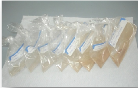
Ilustración 4.6 Muestras de diatomita a diferentes temperaturas al finalizar la prueba térmica
