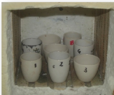
Ilustración 4.5 Muestras de diatomita dentro de la mufla para la prueba térmica
