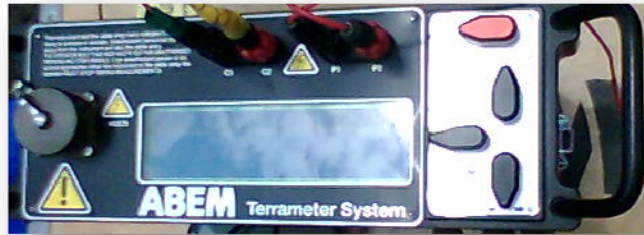
Ilustración 3.8 Equipo para realizar prospecciones geofísicas
