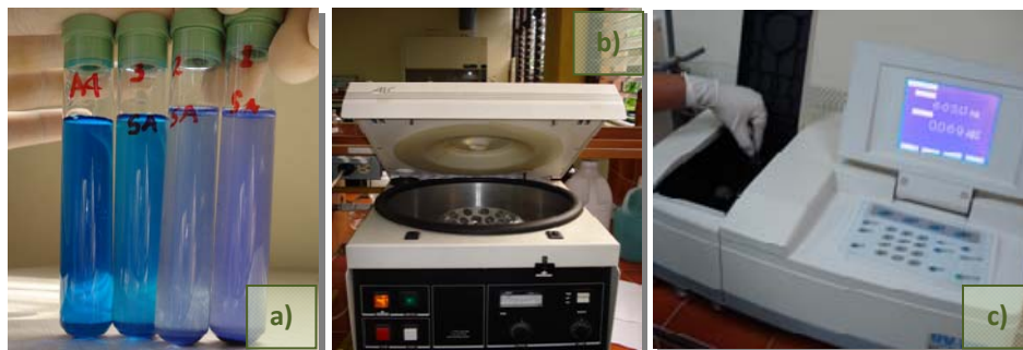
Ilustración 4.18 Prueba de Giles: a) Tubos antes de centrifugar; b) Centrifuga de alta velocidad; c) Espectrofotómetro de doble haz
