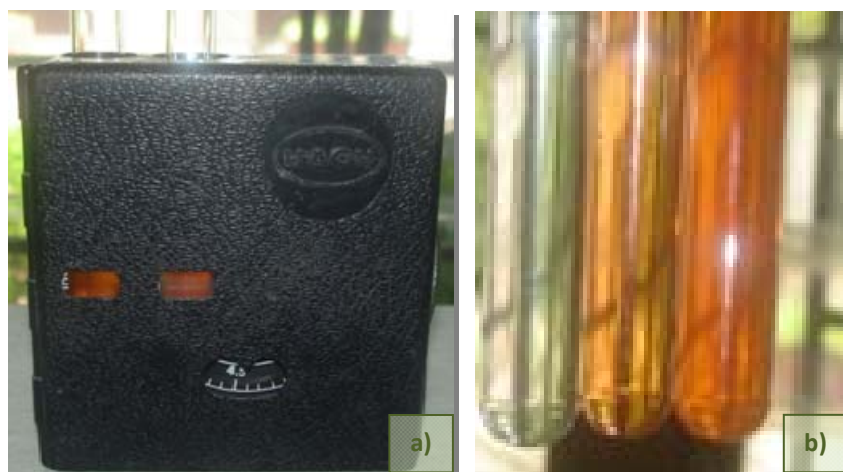
Ilustración 4.17 Determinación de hierro en diatomita: a) Equipo para cuantificar hierro; b) Comparación entre el blanco, dilución 1:2 y muestra
