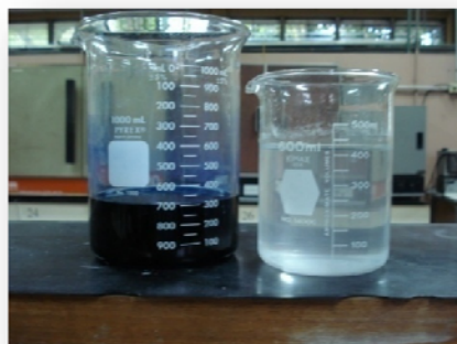
Ilustración 4.23 Comparación de la solución de entrada y salida de la columna de adsorción
