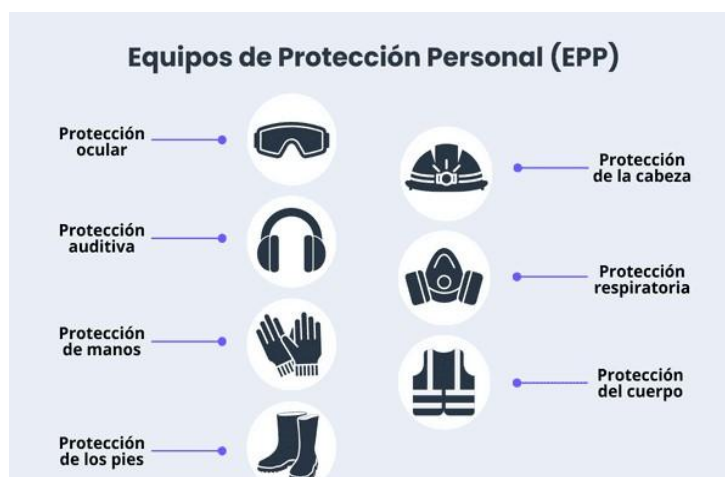
Figura N°1. Equipo de protección personal (EPP) 20
