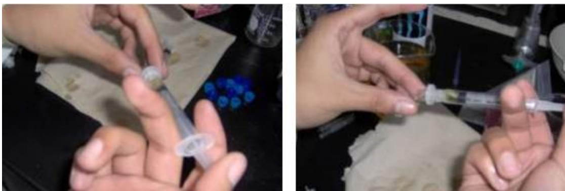
Figura N° 10: Proceso de Filtración de soluciones estándares y muestras a través de membrana nylon 0.45 \mu\text{m} . 30
