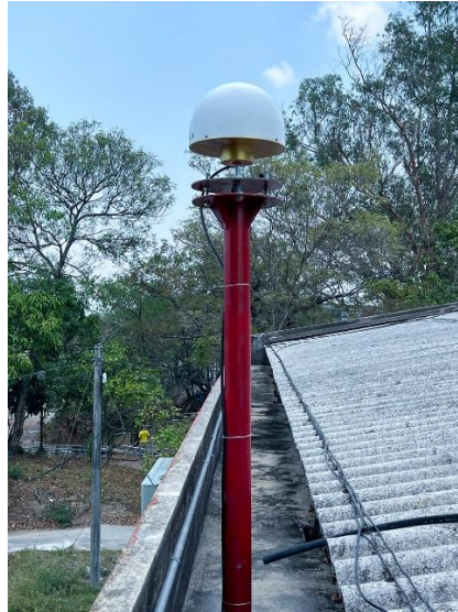
Imagen 3.8 Ubicación de antena base GNSS de Escuela de Ingeniería Civil.
