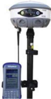
Imagen 3. 10 Equipo utilizado en la medición Fuente: Manual de operación GPS marca Carlson
