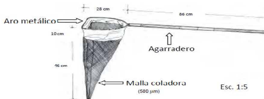
Figura 1. Red "D" para recolectar macroinvertebrados acuáticos (Sermeño Chicas et al 2010b).
