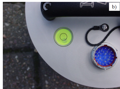
Figura 4.10: Componentes para la calibración del sismómetro. a) Soportes móviles; b) burbuja de calibración.
