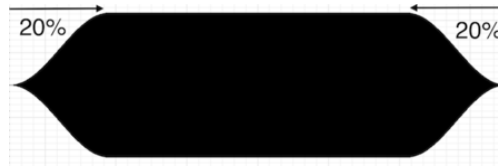
Figura 4.18: Función taper de tipo coseno Tukey con un ancho del 20% en el dominio del tiempo.
