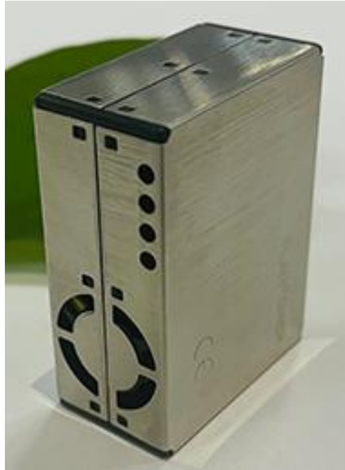
Figura 3.2. Sensor láser PMS5003ST.
