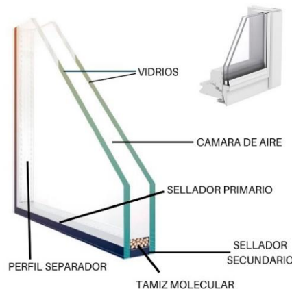
Figura 1.3: Sistema de Doble Vidriado Hermético (DVH).
