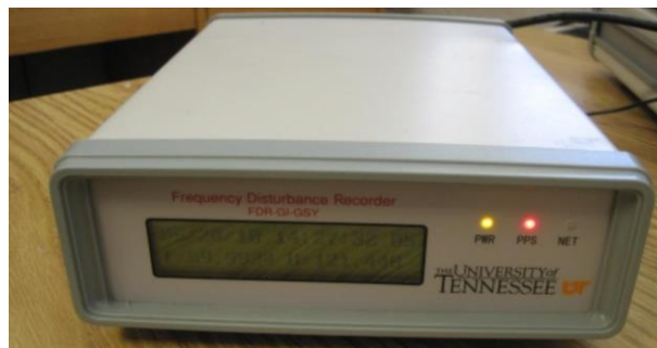
Figura 3.1. Medidor de perturbaciones de frecuencia (FDR), segunda generación, desarrollado por el Laboratorio de Tecnología de la Información de Energía del departamento de Ingeniería Eléctrica y Ciencias de la Computación de la Universidad de Tennessee. Extraído de [38]
