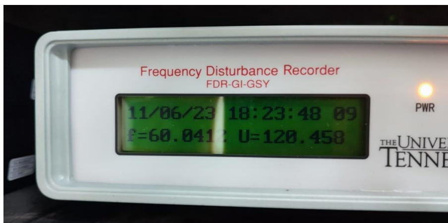
Figura 1.1. Medidor de Perturbaciones de Frecuencia donado a la Universidad de El Salvador (FDR-UES), por el Laboratorio de Tecnología de la Información de Energía de la Universidad de Tennessee.
