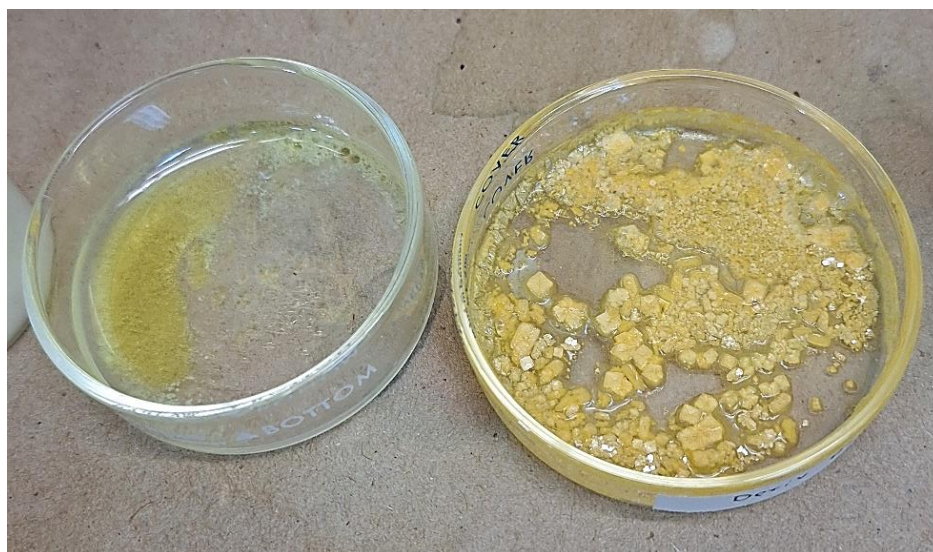
Figura 24. Sólidos obtenidos al evaporar el solvente de las síntesis de FMPONA (izquierda) y BFPONA (derecha).
