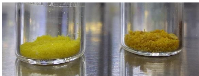
Figura 18. Sólidos obtenidos de las síntesis de FHPONA utilizando soporte en alúmina básica (derecha) y neutra (izquierda).
