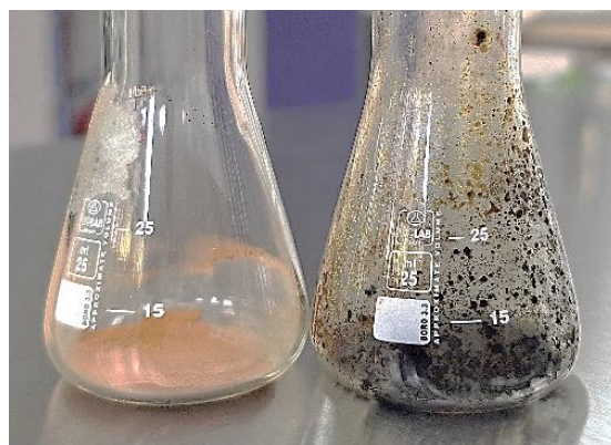
Figura 21. Síntesis de FFONA (izquierda) y FFONA (derecha) utilizando catalizador básico, luego de ser irradiadas en el microondas.
