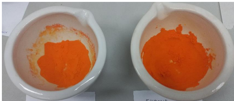
Figura 17. Coloración de la mezcla de reacción de la síntesis de FHPONA usando soporte en alúmina básica y neutra, después de tres días.
