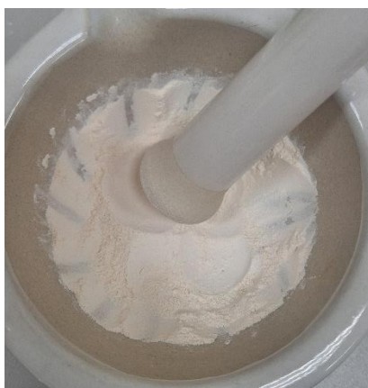
Figura 20. Montaje de FHBONA en alúmina básica adicionando agua.
