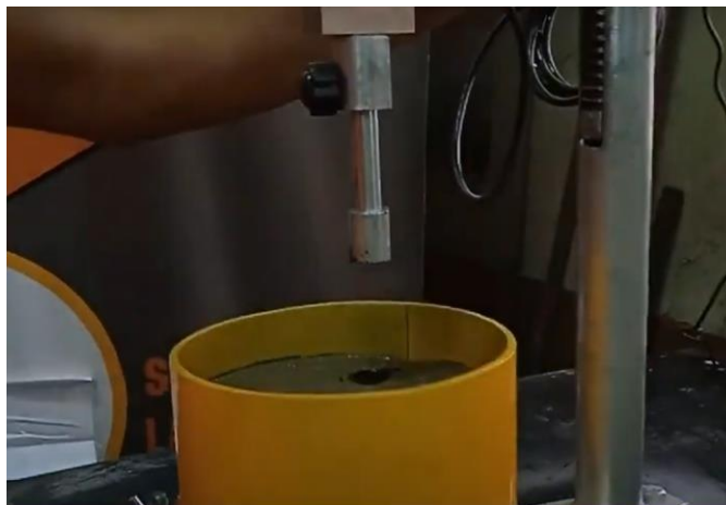
Figura 22 “Prueba de tiempos de fraguado en espécimen de mortero”. Fuente: ICIA El Salvador
