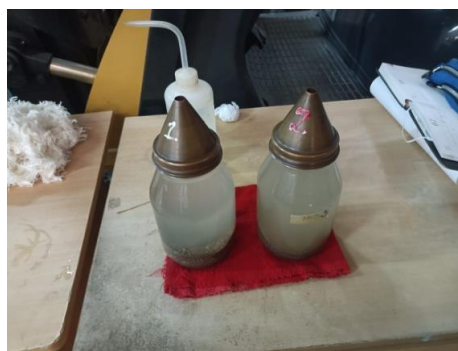
Figura 16 “Llenado del picnómetro”. Fuente: propia
