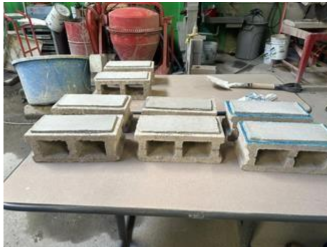
Figura 29 “Morteros aplicados sobre bloques de mampostería”. Fuente: propia
