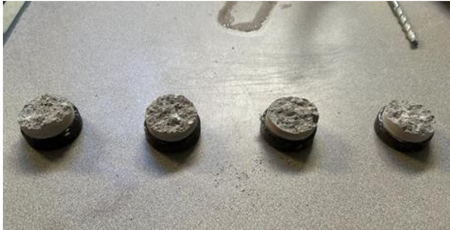
Figura 41 “Fallas presentadas durante ensayo Pull Off”. Fuente: propia
