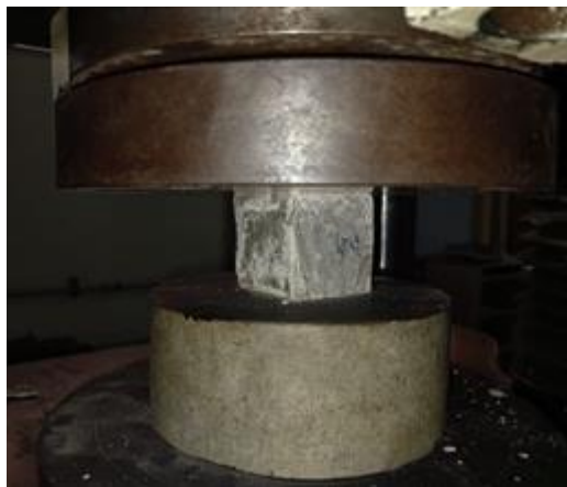
Figura 31 “Realización de ensayo de compresión en espécimen cúbico de mortero”. Fuente: Propia
