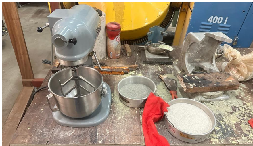
Figura 18 “Mezclador Mecánico y materiales para la mezcla”. Fuente: propia
