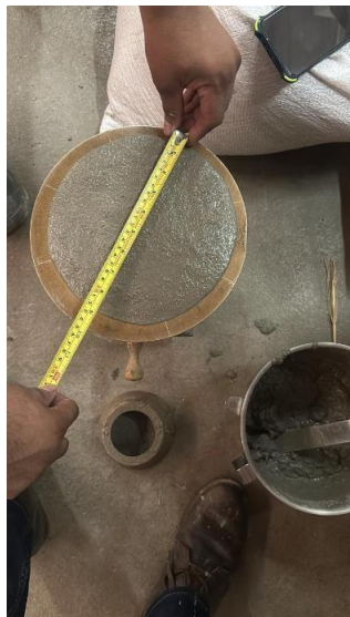
Figura 45 “Determinación de los diámetros para determinación de la Fluidez del mortero”. Fuente: propia
