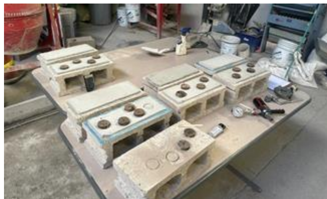
Figura 36 “Bloques de mampostería sometidos a ensayos Pull Off”. Fuente: propia
