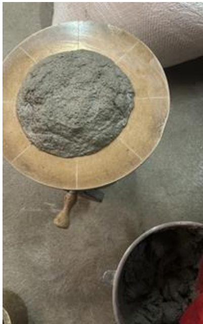
Figura 30 “Realización de ensayo de fluidez en morteros”. Fuente: propia
