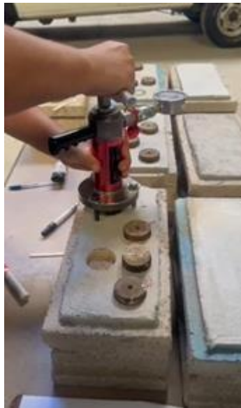
Figura 35 “Realización de Ensayo Pull Off sobre repellos aplicados a bloques de mampostería”. Fuente: propia
