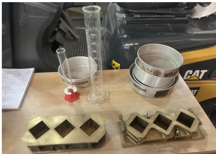
Figura 24 “Moldes de cubos de mortero para resistencia a la compresión” . Fuente: propia
