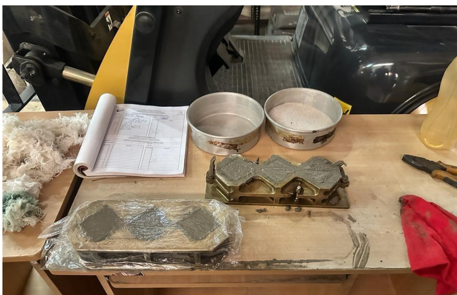
Figura 26 “Cubos de morteros para determinación de la resistencia a compresión a los 7 y 28 días”. Fuente: propia
