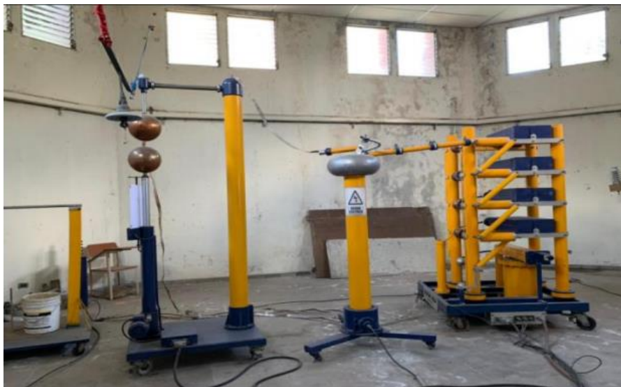
Ilustración 6 Máquina de pruebas de Impulso en el Laboratorio de Potencia de Ingeniería Eléctrica de la Facultad de Ingeniería y Arquitectura en la Universidad de El Salvador.
