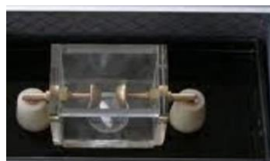
Ilustración 8 Copa estándar para la prueba de rigidez dieléctrica
