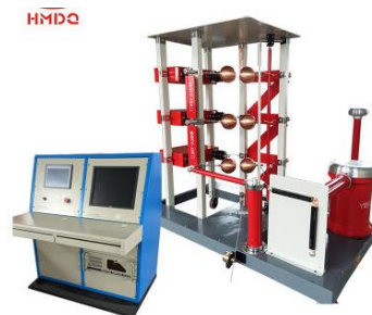
Ilustración 28 Generador de impulso tipo rayo
