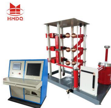
Ilustración 26 Generador de impulso tipo rayo
