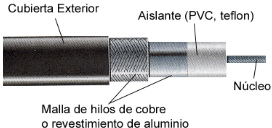
Imagen 2.10.1. Cable coaxial.
