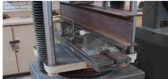
Fotografía No. 11: Prueba ensayo a flexión en perfiles metálicos.
