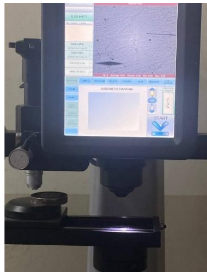
Fig. 2.27. Posición del porta probeta bajo el lente.
