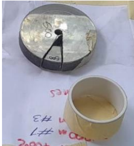
Fig. 2.22. Corte de la muestra metalográfica.
