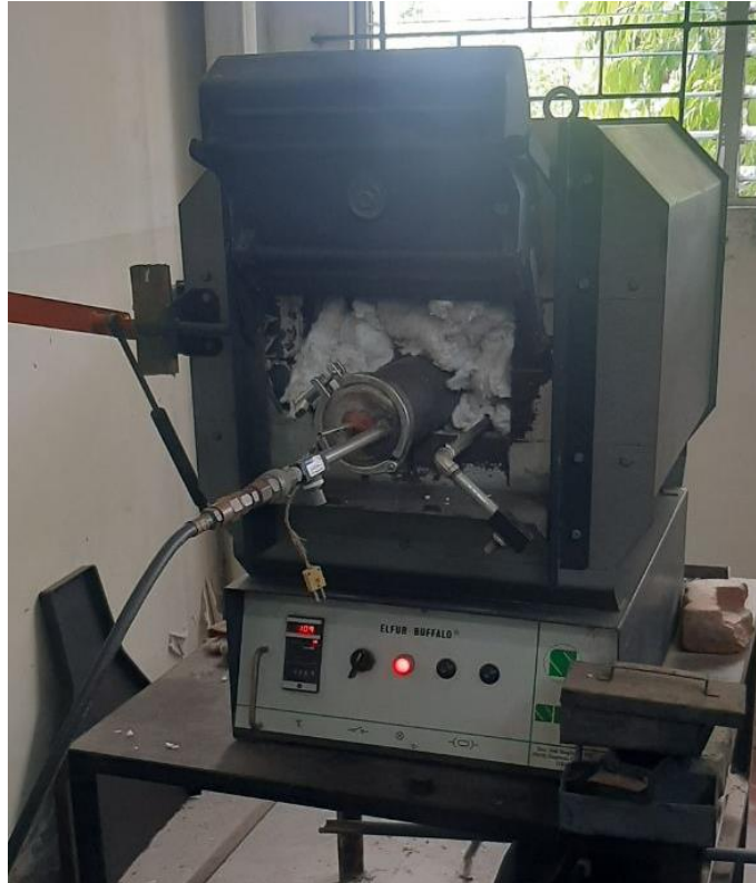
Fig. 2.20. Configuración de la cámara de gas inerte.
