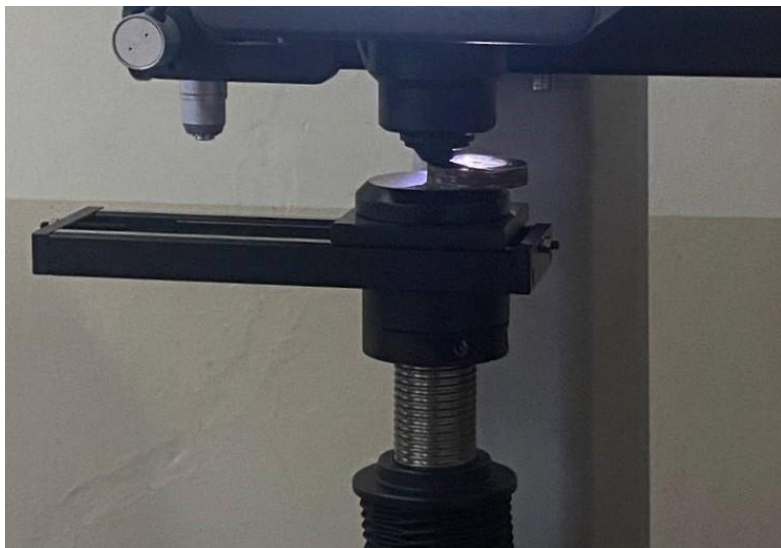
Fig. 2.26. Posición del porta probeta durante la prueba de dureza.
