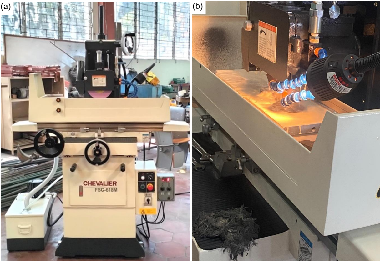
Fig. 2.9. Proceso de rectificado: a) Rectificadora; y b) probeta siendo rectificada.
