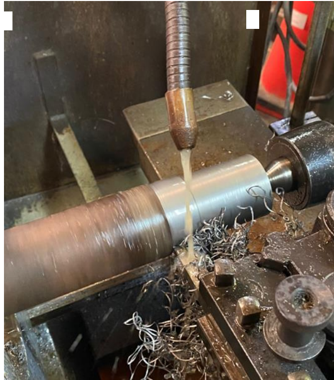
Fig. 2.4. Cilindrado de la barra de acero SAE 1020.
