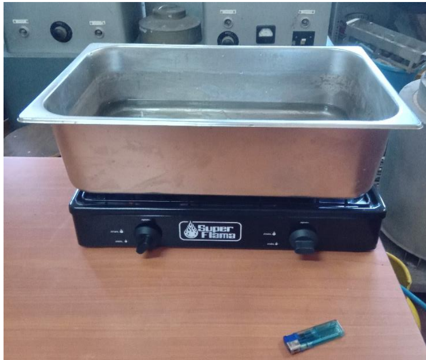
Fig. 2.18. Bandeja que contiene soda cáustica a 60 °C sobre cocina a gas de dos quemadores.
