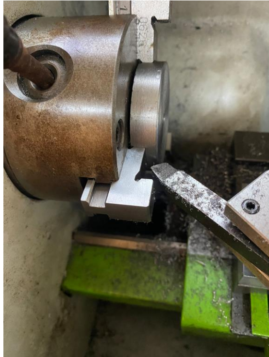
Fig. 2.8. Proceso de biselado de los discos.
