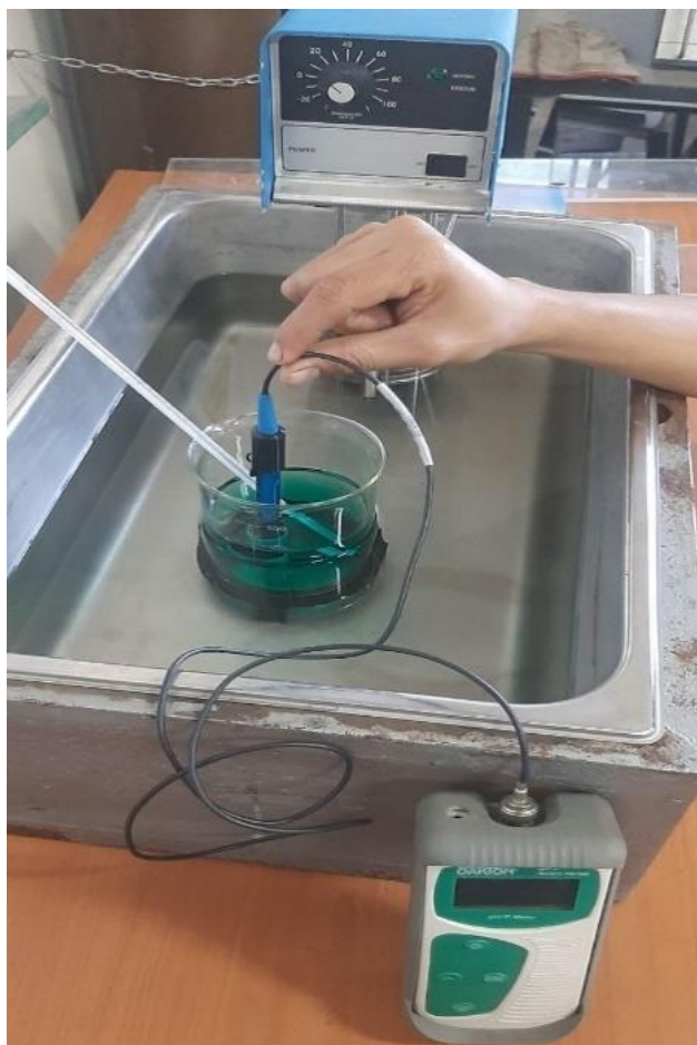
Fig. 2.13. Ensayo en un vaso Beaker de 500 ml.
