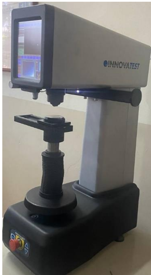
Fig. 2.25. Durómetro INNOVATEST, modelo VERZUS 750CCD.
