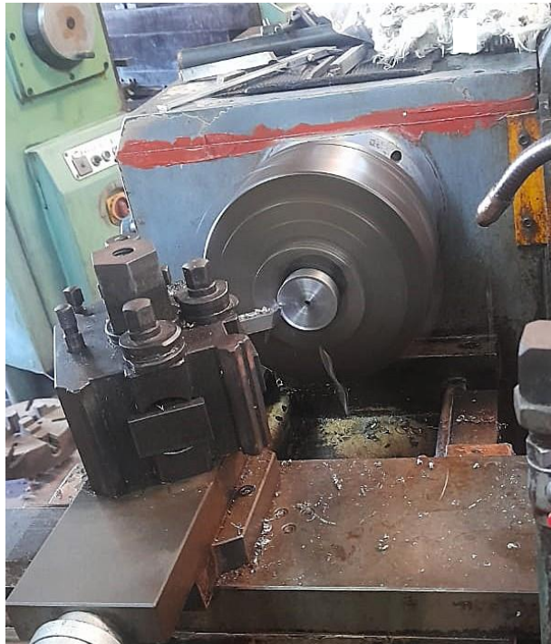
Fig. 2.7. Proceso de refrentado de las caras.
