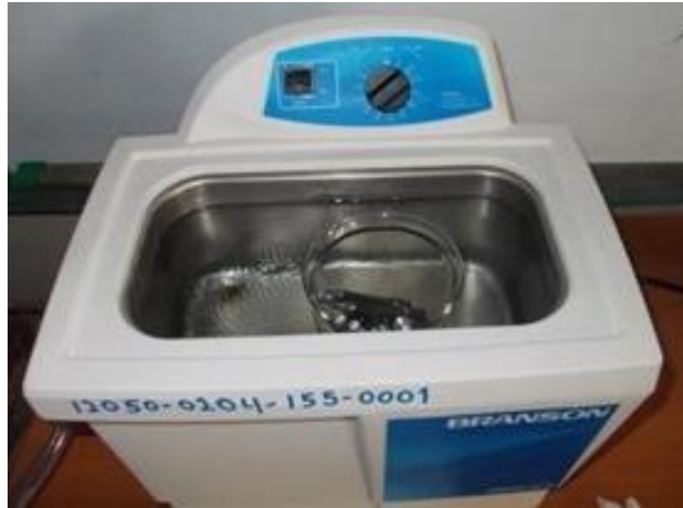
Fig. 2.17. Cámara de baño ultrasónico utilizada.
