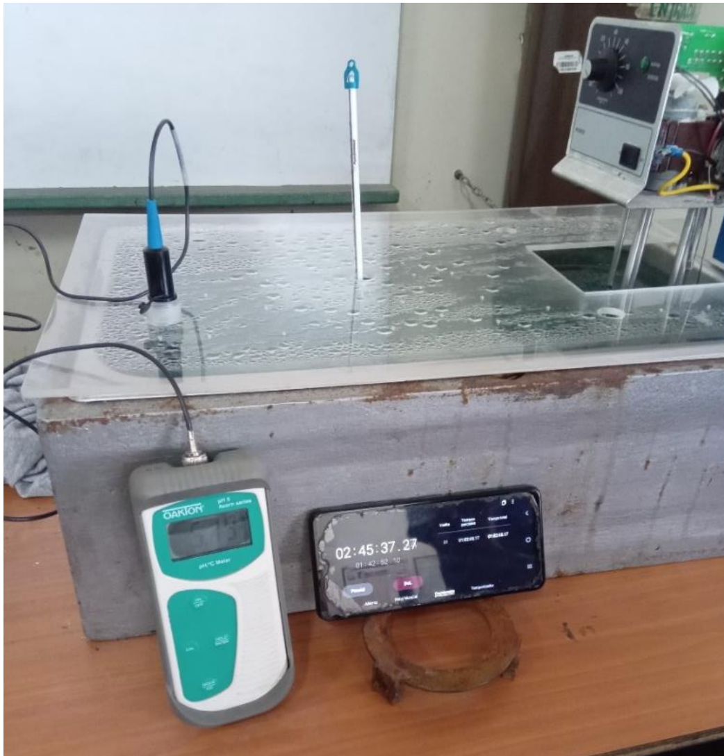
Fig. 2.12. Sistema para la deposición auto catalítica de recubrimientos de Ni-P.
