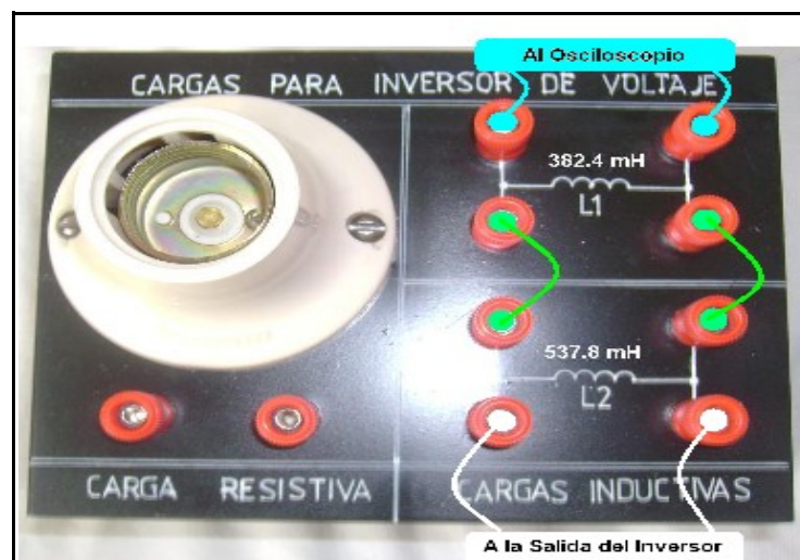
Figura H.21. Forma de conectar la bobina L2 = 537.8 \text{ mH} al inversor monofásico.
