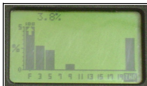
Figura 93. THD de la red eléctrica.
