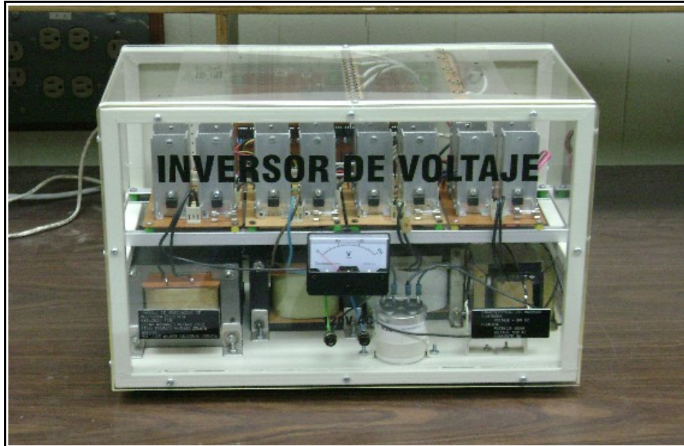
Figura 94. Inversor multinivel de 4 etapas, 81 niveles construido.
