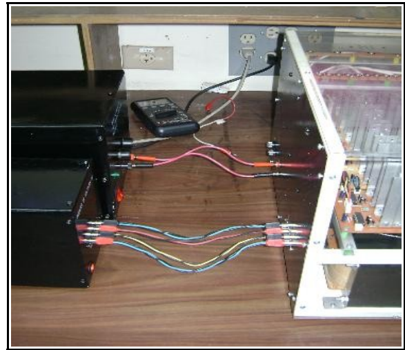
Figura H.17. Forma de Conectar las fuentes DC al inversor
