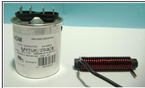
Figura 71. Capacitor e inductor utilizados para el filtro LC.
