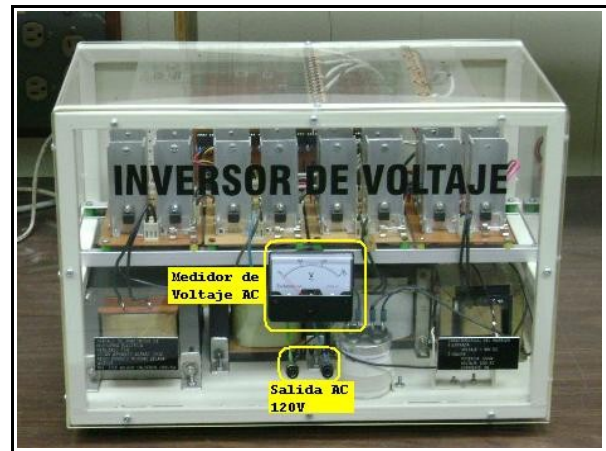
Figura H.14. Descripción de la parte frontal del Inversor
