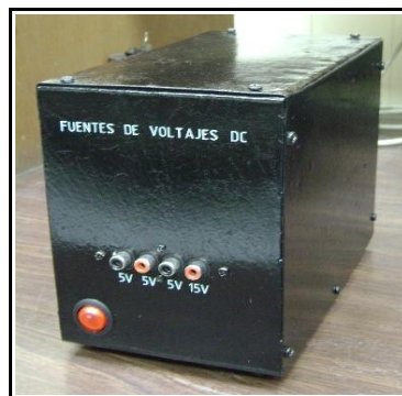
Figura 74. Fuentes de voltajes DC, tres de 5V y una de 15V.
