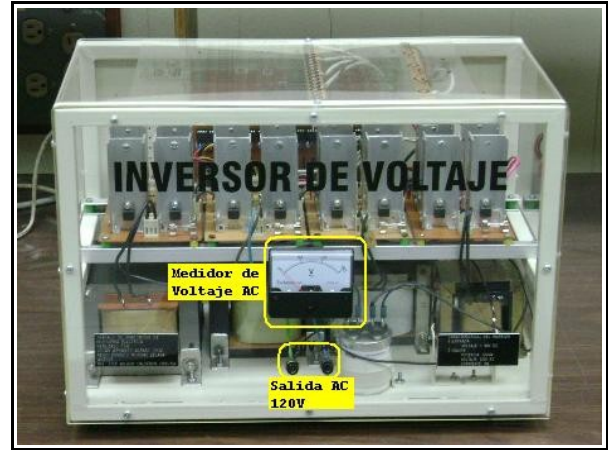
Figura G.2. Descripción de la parte frontal del Inversor
