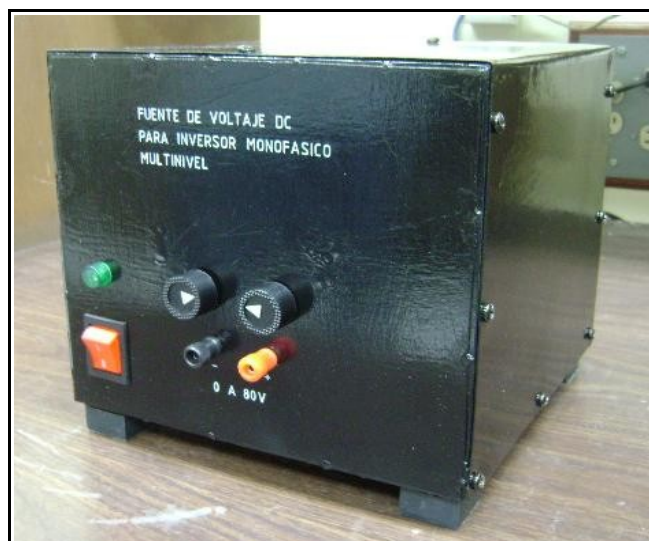
Figura 77. Fuente de voltaje de 80V DC.
