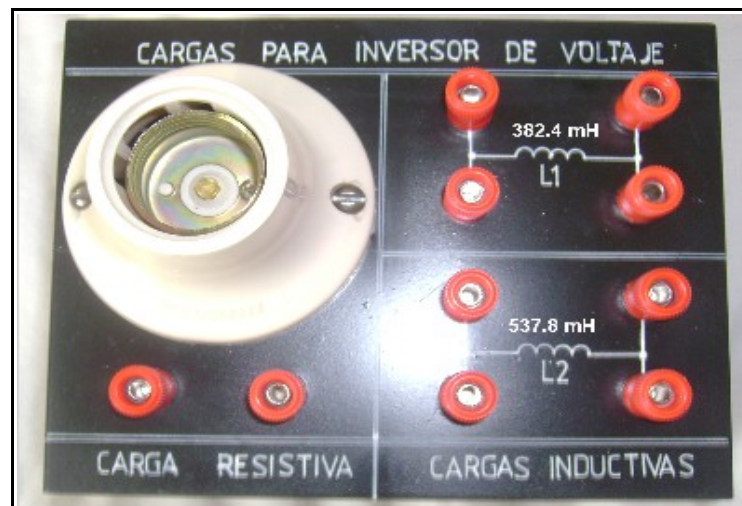
Figura H.12. Cargas para el inversor monofásico.
