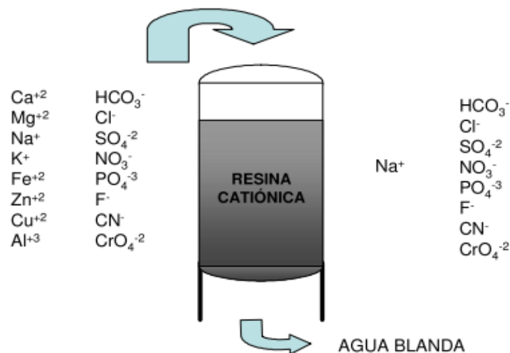
Figura N° 4. Tanque con resinas de intercambio iónico en ciclo sódico, para ablandamiento del agua, al intercambiar sodio por otros cationes, cuando fluye el agua y se pone en contacto con la resina. 13
