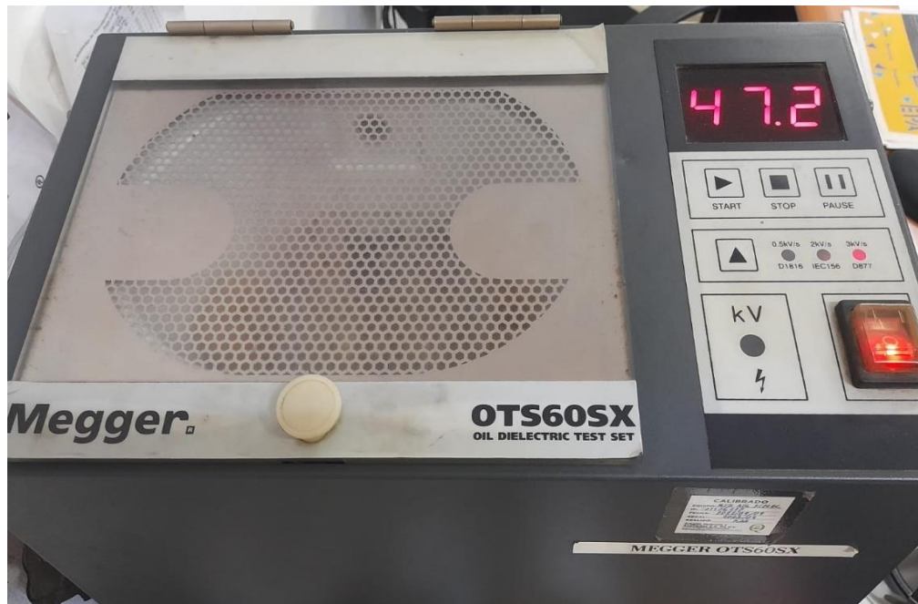
Figura 3.35: Segundo resultado de rigidez dieléctrica transformador 1
