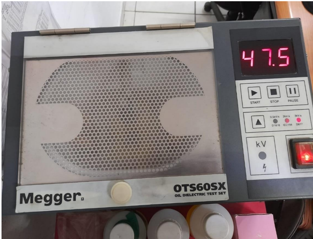
Figura 3.38: Segundo resultado de rigidez dieléctrica transformador 2
