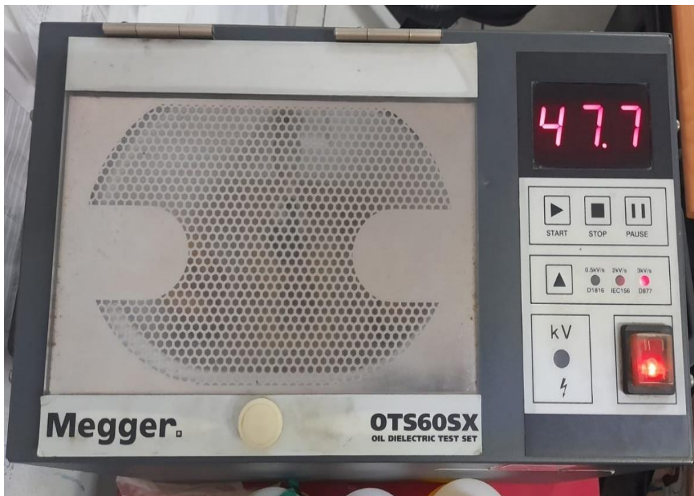
Figura 3.39: Tercer resultado de rigidez dieléctrica transformador 2
