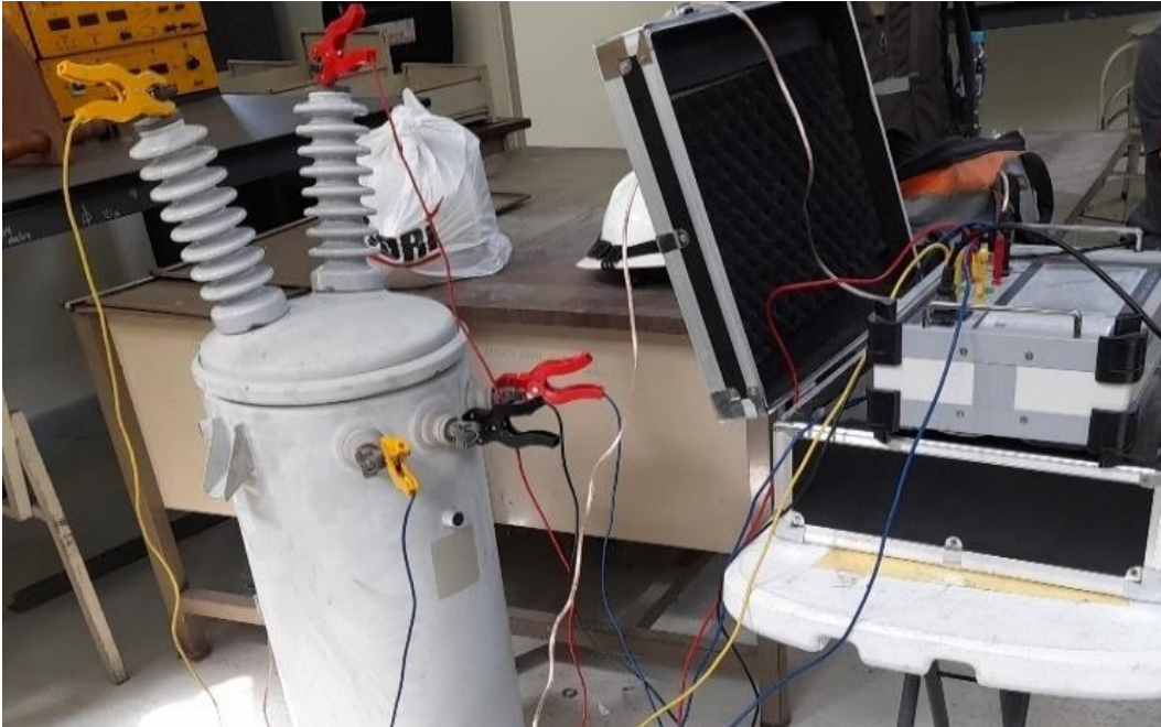
Figura 2.21: Conexión de ratiometro con equipo Huazheng modelo OTS60SX
