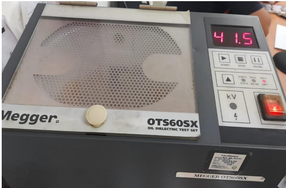
Figura 3.36: Tercer resultado de rigidez dieléctrica transformador 1
