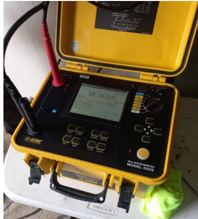
Figura 1.4: Megóhmetro 6555 para prueba de resistencia de aislamiento.
