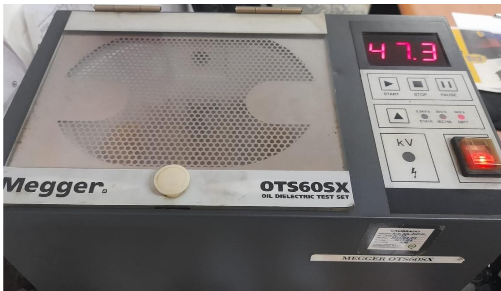
Figura 3.34: Primer resultado de rigidez dieléctrica transformador 1
