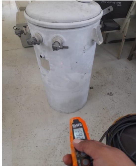
Figura 3.5: Toma de temperatura para selección del factor de corrección – T2
