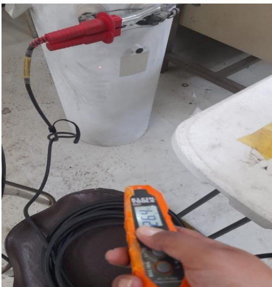
Figura 3.1: Toma de temperatura para selección del factor de corrección – T1
