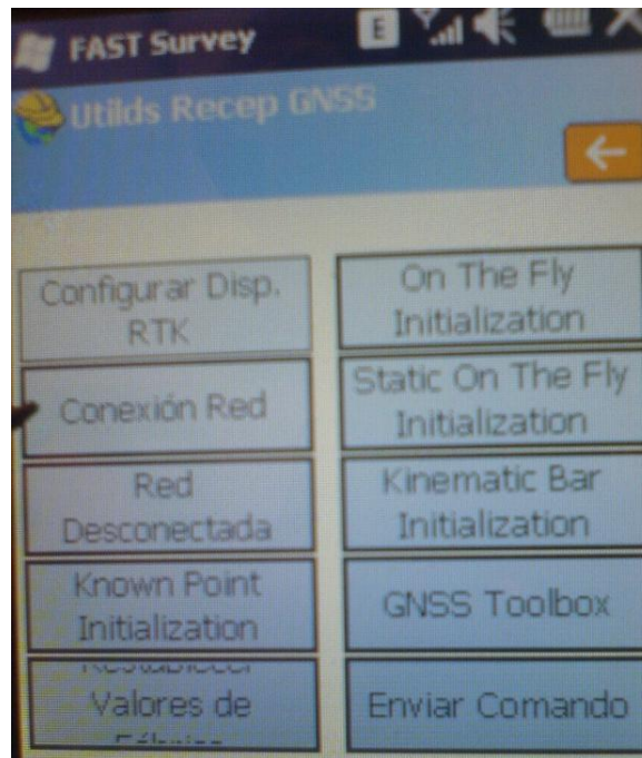
Figura 5.14 Realizando la conexión del Rover con el Caster.
