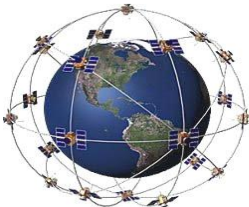
Figura 3.12 El segmento espacial GPS y su distribución.
