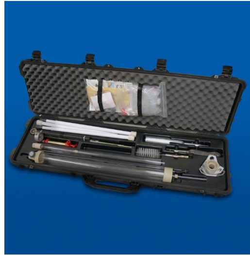
Figura 3.4 Izq.: Toma de medidas de permeabilidad. Der. Kit para montaje de Permeámetro de Guelph.
