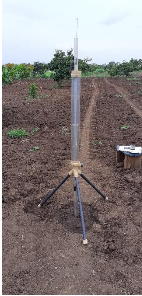
Figura 3.4 Izq.: Toma de medidas de permeabilidad. Der. Kit para montaje de Permeámetro de Guelph.
