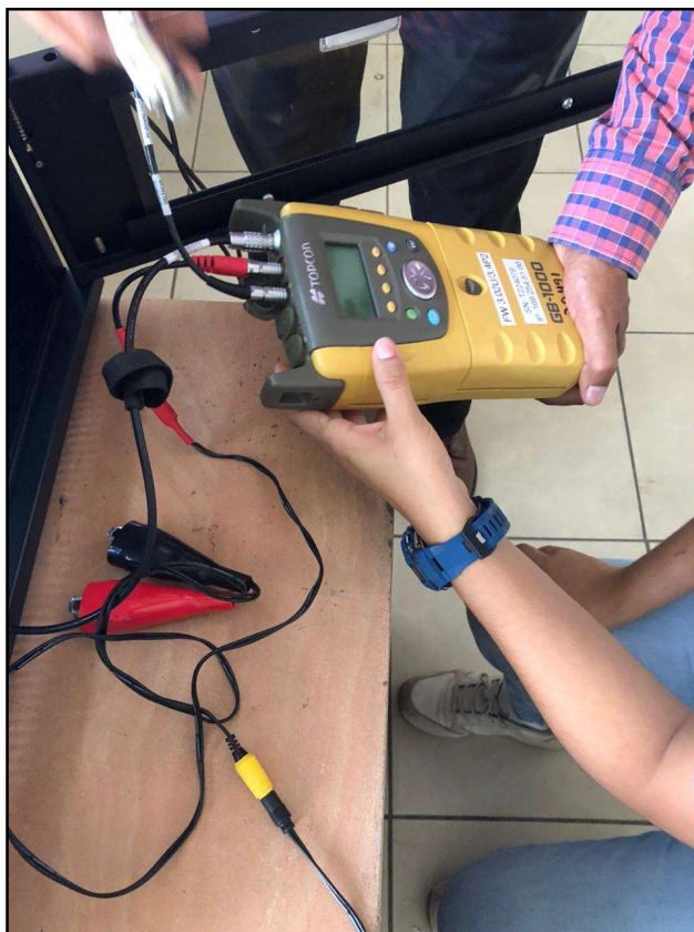
Figura 0.9 Receptor conectado a la fuente de energía, a la PC y a la antena GPS.
