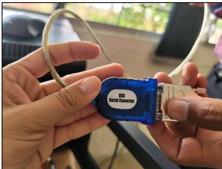
Figura 0.10 Cable de comunicación tipo RS 232 que conecta el receptor con la PC.
