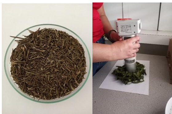
Figura 16. Determinación de color en muestra deshidratada.
