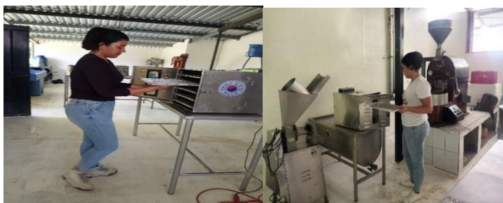
Figura 12. Deshidratado por aire forzado de especies aromáticas.
