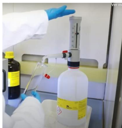
Figura N° 6. Agregación de ácido sulfúrico a la muestra 4 .
