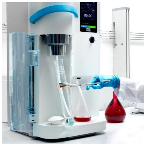
Figura N° 8. Equipo para la destilación de la muestra (destilador de Kjeldahl) 15 .
