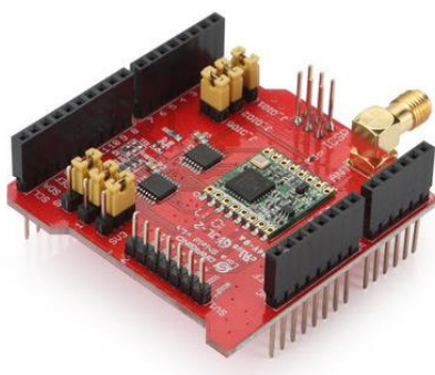
Figura 21: Placa Dragino sx127x compatible con Lora.
