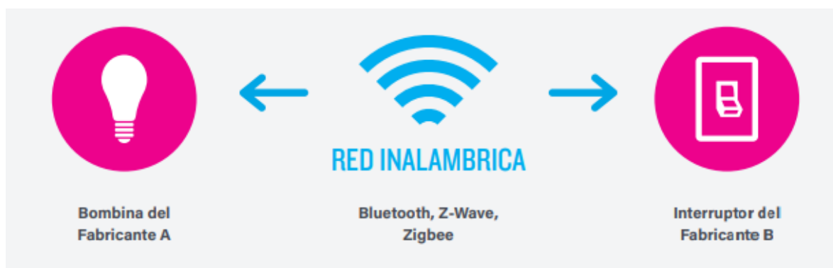
Figura 1: Ejemplo de comunicación dispositivo a dispositivo Ejemplo de comunicación dispositivo a dispositivo.
