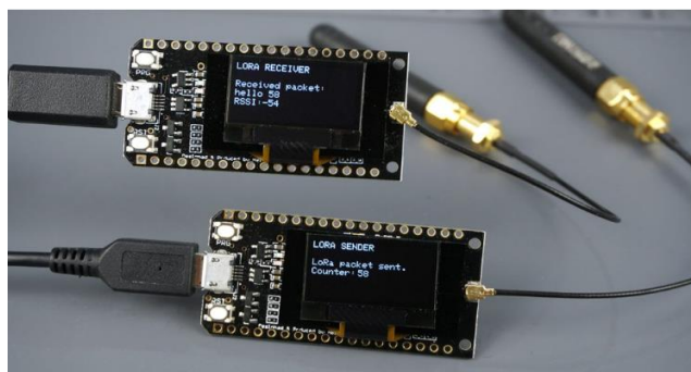
Figura 22: Placa TTGO ESP32 a usar en el prototipo.
