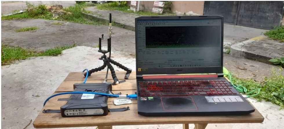
Figura 110: Equipo utilizado para medir el nivel de recepción de señal.
