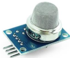
Figura 27: Sensor MQ2 para detectar gas y humo.
