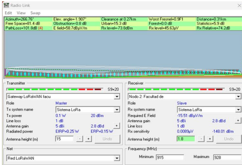
Figura 45: Enlace entre gateway y nodo 2.
