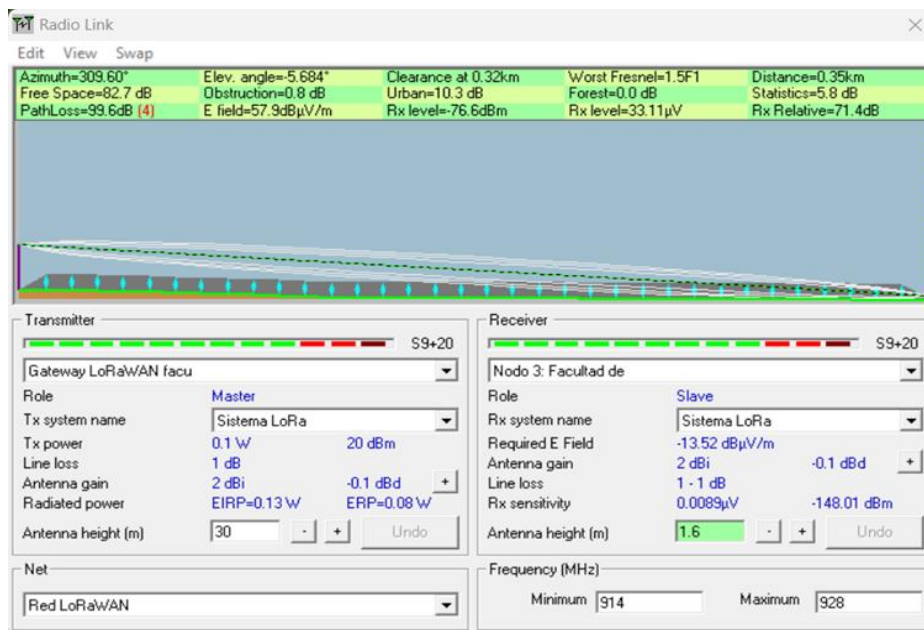
Figura 46: Enlace entre gateway y nodo 3.
