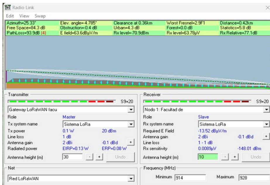
Figura 43: Enlace entre gateway y nodo 1.
