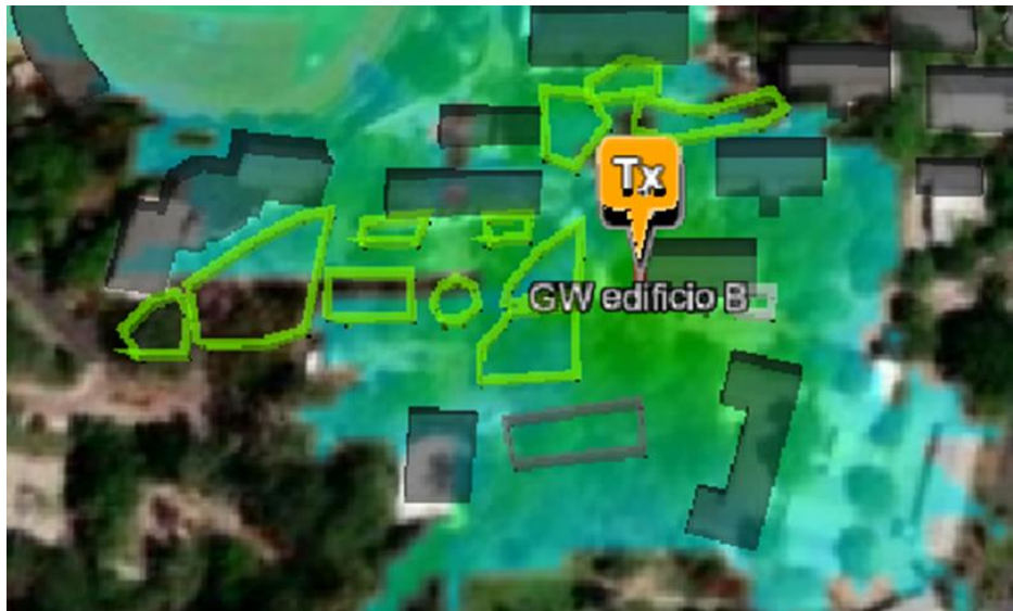
Figura 152: Gateway ubicado en el edificio B de la facultad de Ingeniería y Arquitectura.
