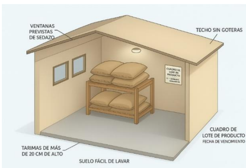
Figura 3- Diagrama de referencia de bodega escolar conforme a (Normas ISO 6322-1 Y RTCA 67.06.55:09).
