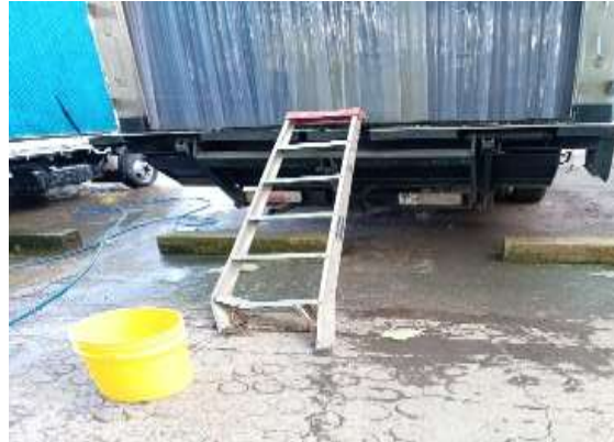
Figura 26: Escalera en mal estado
