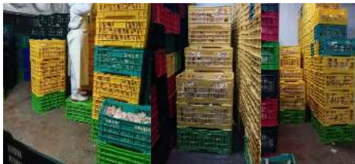
Figura 22: Acomodación inadecuada de torres de jabas
