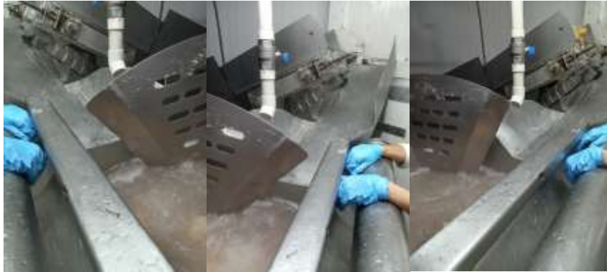
Figura 13: Riesgo por atrapamiento de miembros superiores
