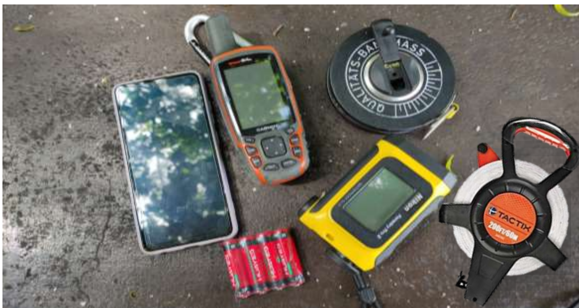
Figura 2. Equipo usado para la toma de datos de campo (Celular, GPS, Cinta diamétrica, hipsómetro láser y cinta métrica).
