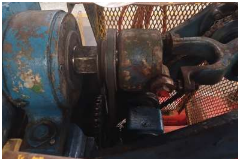
Figura 34. Correas con ramales sin resguardo
