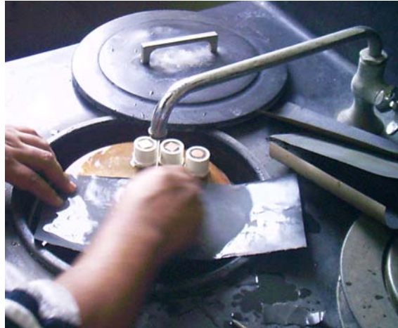
Figura 5.7. Pulido preliminar con papel abrasivo.
