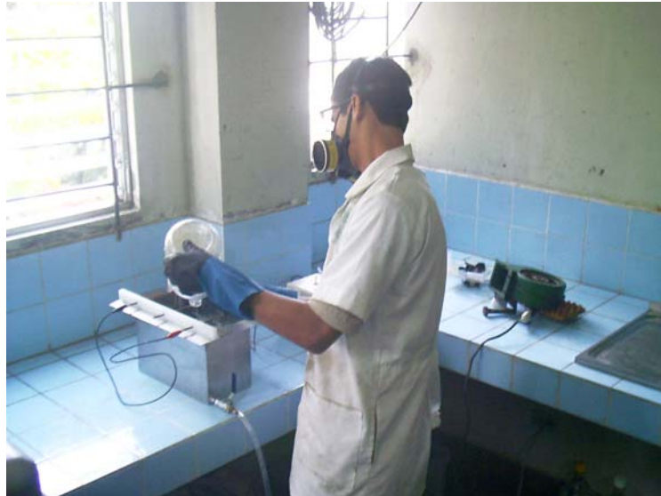
Figura 5.9. Carga del electrolito en el tanque.
