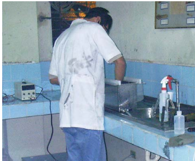
Figura 5.8. Enjuague del tanque antes de iniciar cada ensayo
