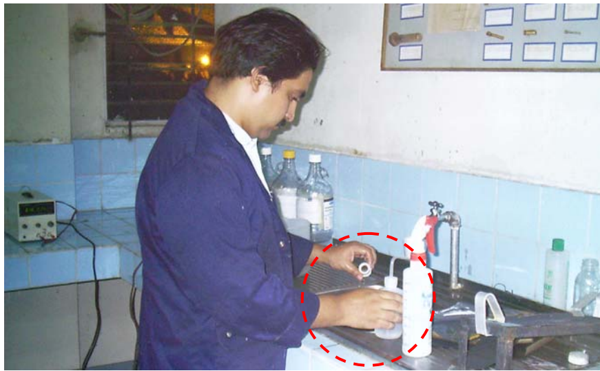
Figura 5.10. Enjuague de las probetas con etanol
