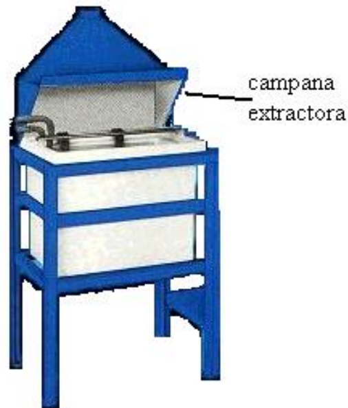
Figura 3.21. Tanque de electropulido con campana de extracción lateral.
