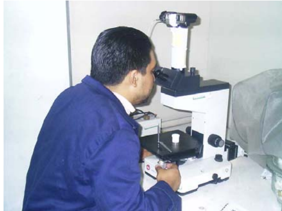
Figura 5.11. Observación de las probetas en el microscopio metalográfico.
