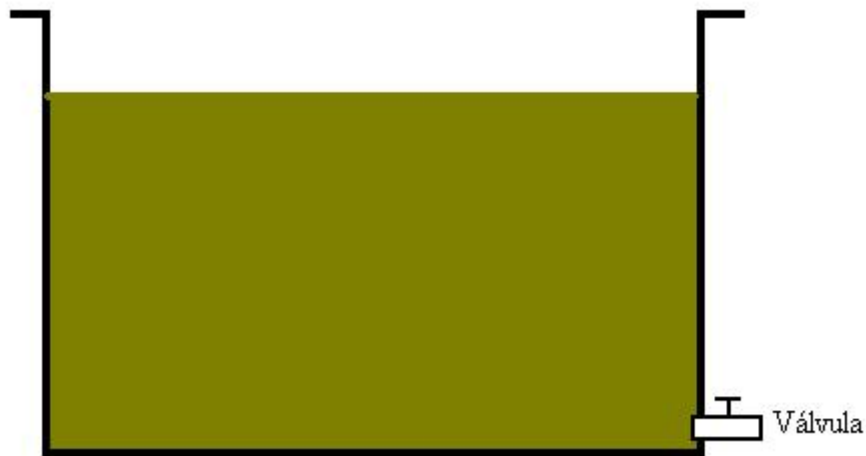
Figura 3.28. Salida para desagüe del tanque.
