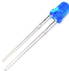
Fig. 3.26. Diodo emisor de luz, led, color azul a utilizar.
