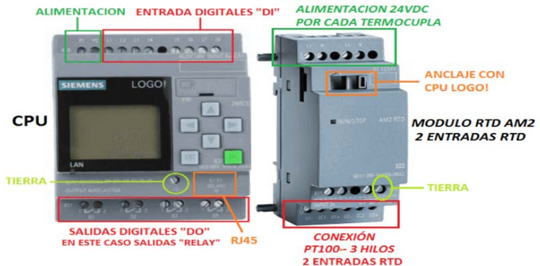
Fig. 1.11. Partes del PLC LOGO! SIEMENS.
