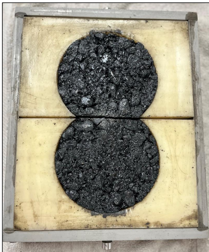
Figura 16. Dos especímenes, luego de ser cortados, montados en moldes de teflón y colocados dentro de la armazón de ensayo. Fuente: Asfalca, S.A. DE C.V.
