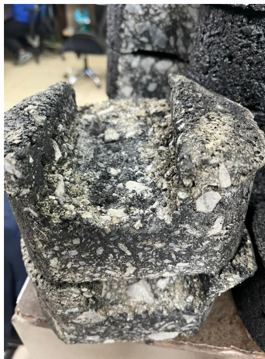
Figura 47. Muestra luego de fallar por desnudamiento (55°C – 30,000)
