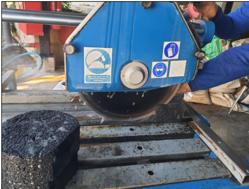
Figura 15. Proceso de corte de especímenes para posterior montaje en equipo de Rueda de Hamburgo Fuente: Asfalca, S.A. DE C.V.
