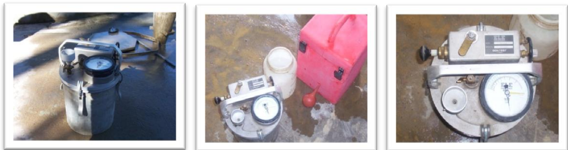
Figura 3.25: Equipo a utilizar, para la determinación del contenido de aire del concreto fresco.
