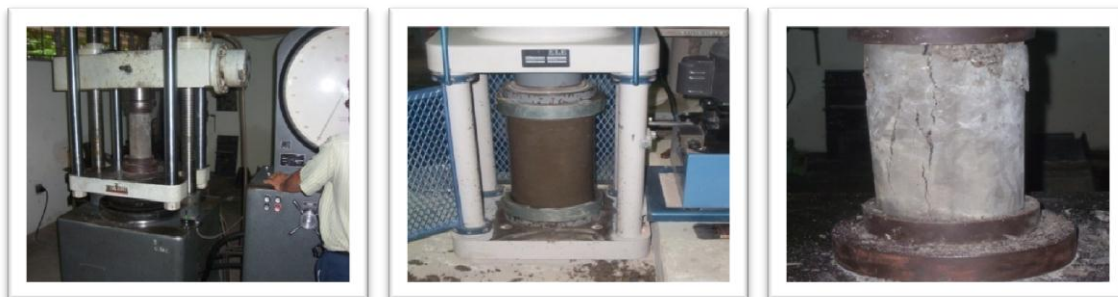
Figura 3.28: Ilustración del ensayo de Resistencia a la Compresión, en cilindros de concreto.
