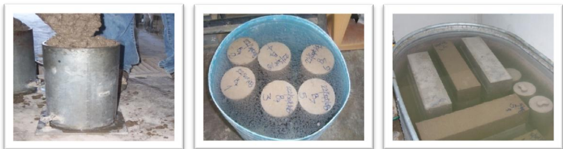
Figura 3.26: Elaboración y curado de espécimenes de concreto en laboratorio.
