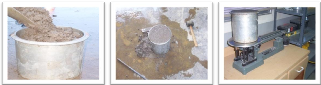
Figura 3.22: Peso volumétrico del concreto fresco.
