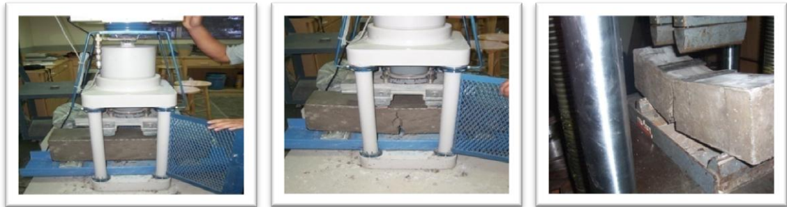
Figura 3.29: Ilustración del ensayo de Resistencia a la Flexión, en viguetas de concreto.
