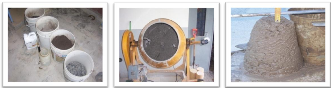
Figura 4.6: Proceso de proporcionamiento, mezclado en concretera y ensayo de revenimiento del concreto.
