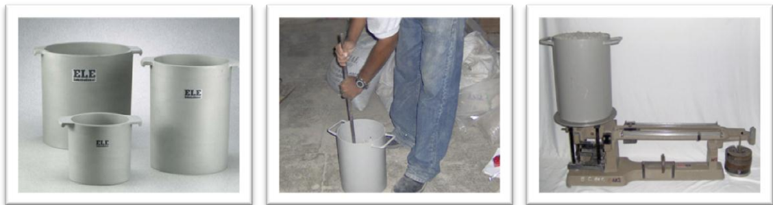
Figura 3.17: Equipo a utilizar, para la determinación del peso volumétrico varillado de la grava.
