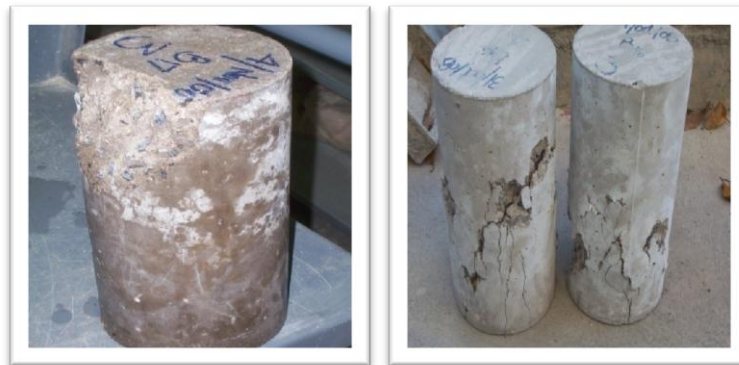
Figura 5.3: Fallas observadas en los especímenes de prueba a compresión.
