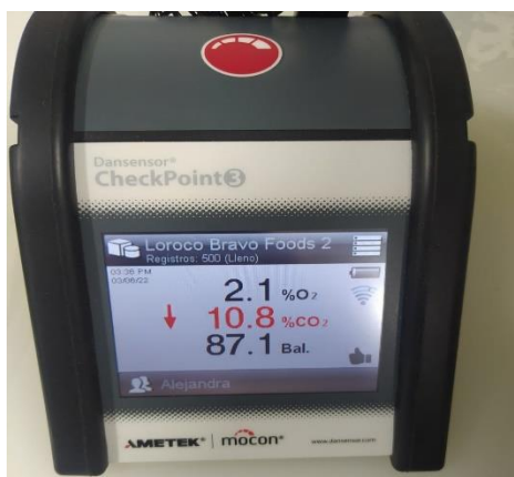
Figura 13: Verificación correcta de gases para atmosfera modificadas
