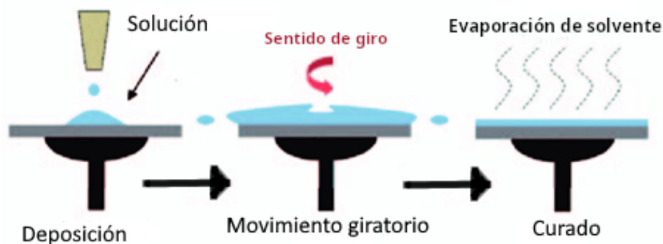
Figura 1.8: Esquema de deposición mediante técnica recubrimiento giratorio, las flechas negras indican el siguiente paso en la metodología de preparación, modificado con el permiso del autor de la referencia [33]
