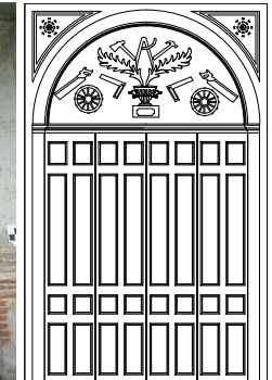
Esc. 1:100 DAÑO PROMEDIO 15% Puerta de acceso principal, conserva la estructura, los tableros, se ha decolorado por el tiempo y esta desnivelada.
