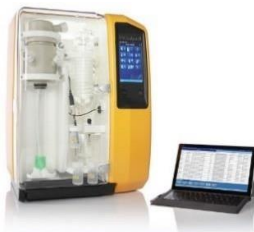
Figura N° 10. Valoración de la muestra automáticamente para determinar el porcentaje de nitrógeno 25
