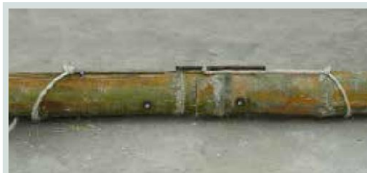
Dos cañas unidas con soga de presión y colocación de dos pernos.
