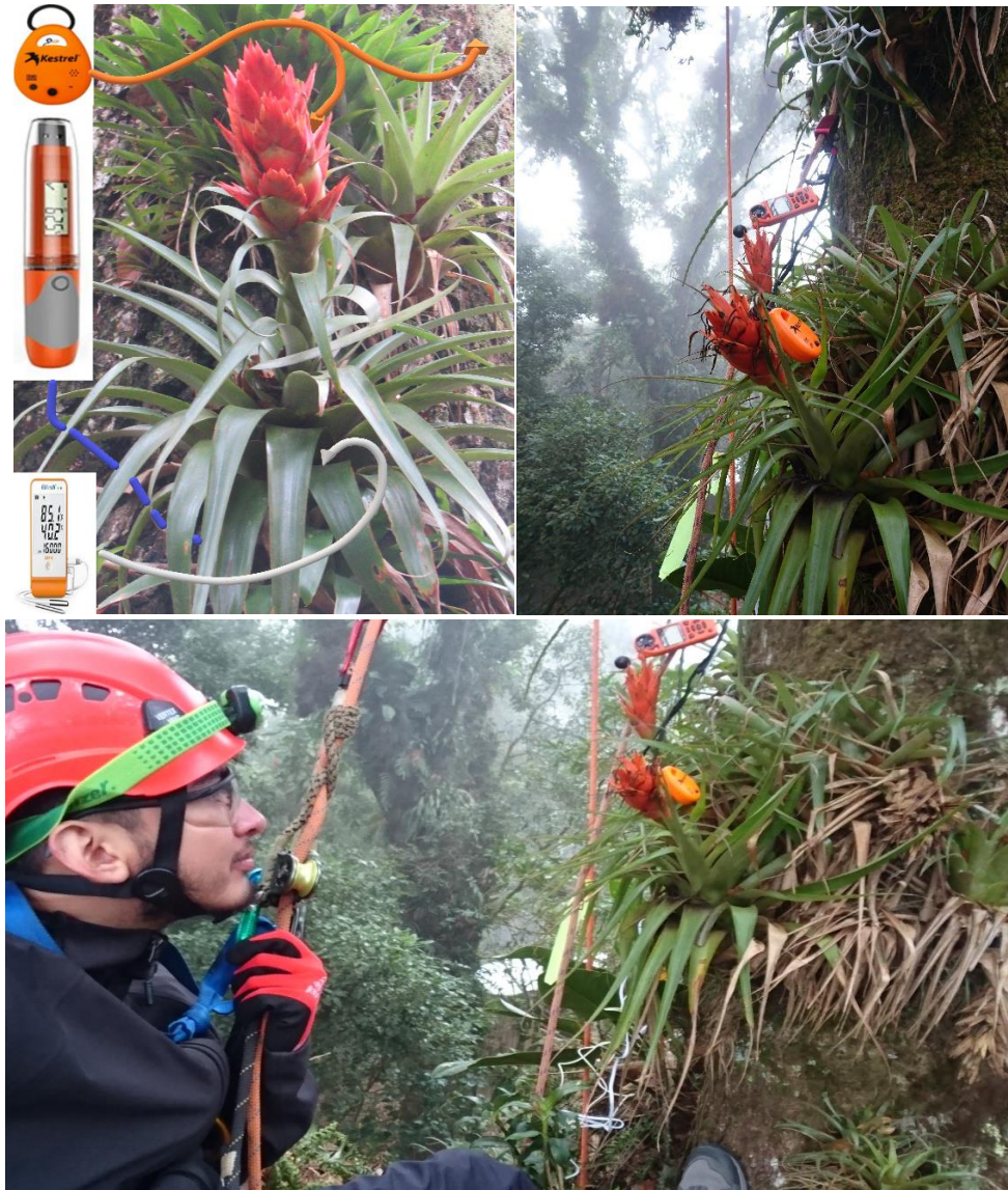
Figura 6. Ubicación de data loggers en bromelias de tanque epífitas para toma de datos de temperatura y humedad.
