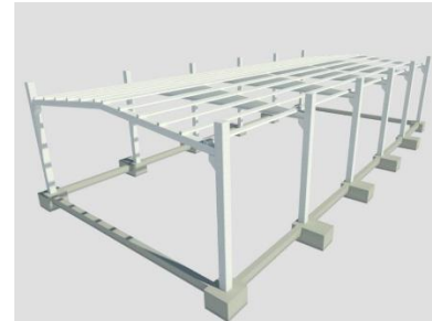
Imagen 1. Nave prefabricada de hormigón
