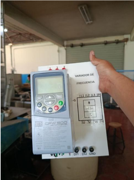
Ilustración 11. Variador de frecuencia WEG CFW 500
