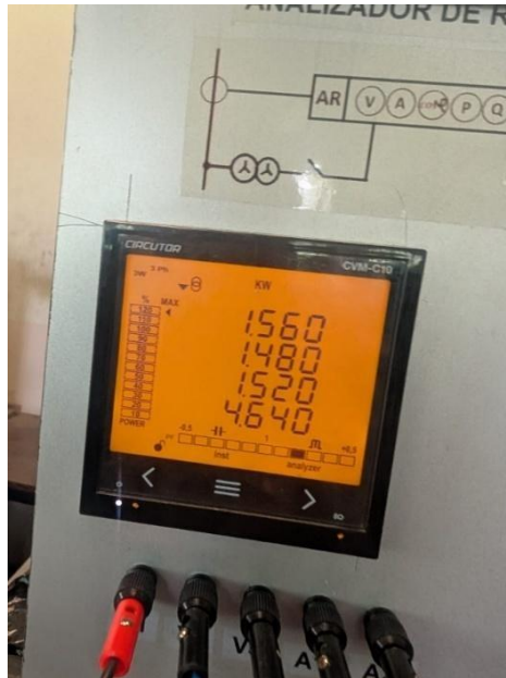
Figura 3.11. Mediciones de potencia por fase en rotor bloqueado en kW. (Fuente: autores)
