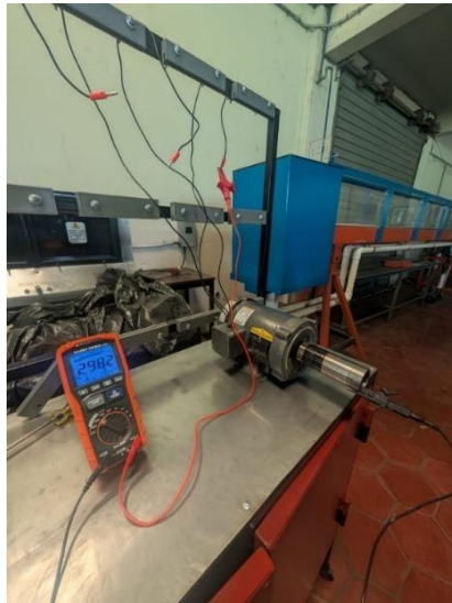
Figura 3.12. Resistencia de fase 2 prueba de CD. Valores en Megaohmios. (Fuente: autores)
