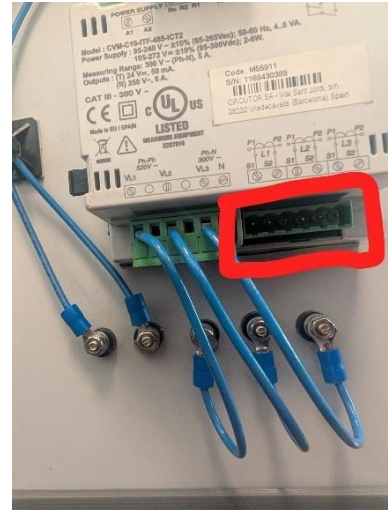
Ilustración 14. borne de conexión para transformadores de corriente. (fuente: autores)
