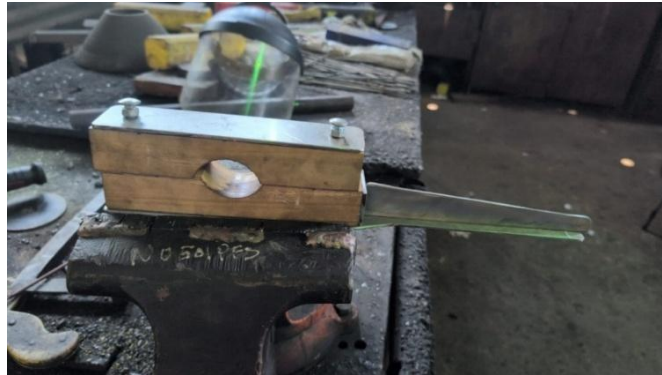
Figura 3.5. Construcción palanca a las zapatas del freno. (Fuente: autores)
