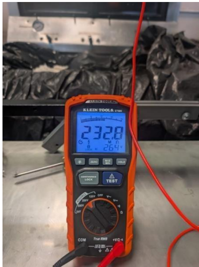
Figura 3.13. Resistencia de fase 2 prueba de CD. Valores en Megaohmios. (Fuente: autores).
