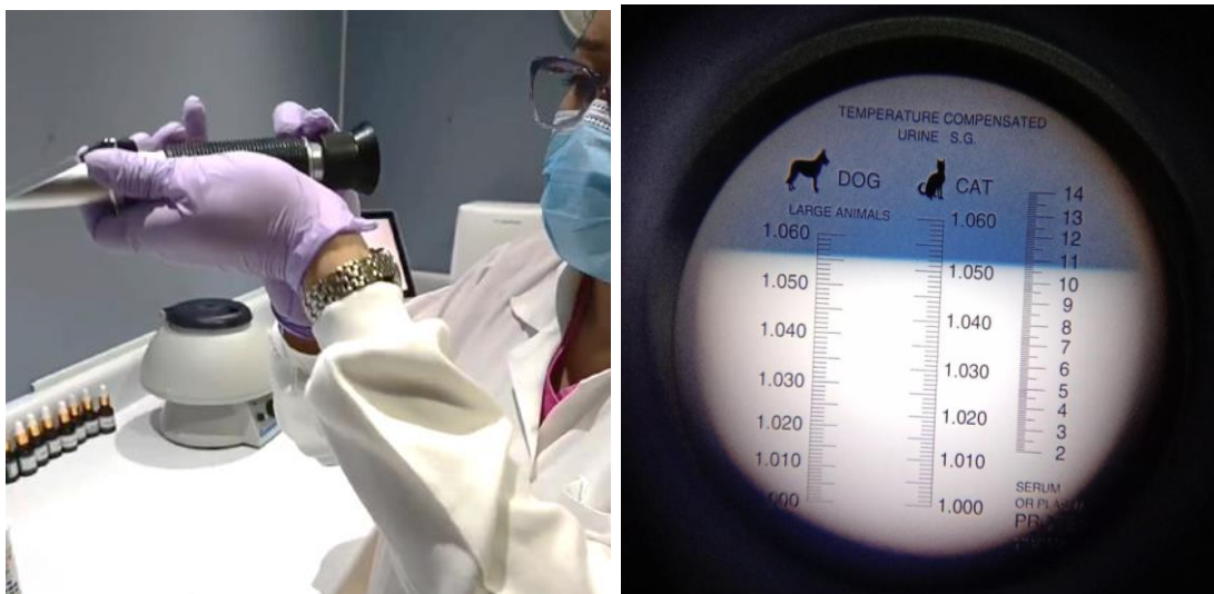
Figura 37. Izquierda: Utilización de refractómetro de mano; Derecha: Determinación de la densidad específica de la orina en un paciente canino.
