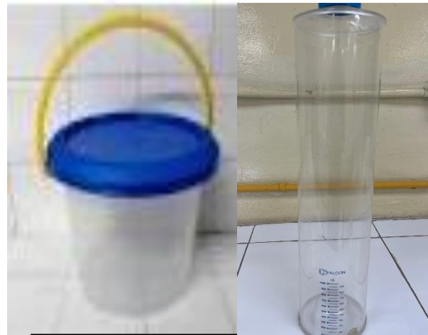
Figura 1. a) Balde de 3 litros b) fermentador, usados como reactor en
