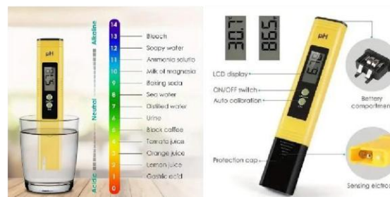
Figura 1: escala de pH y partes de un pH metro.
