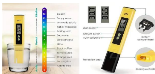
Figura 1: escala de pH y partes de un pH metro.
