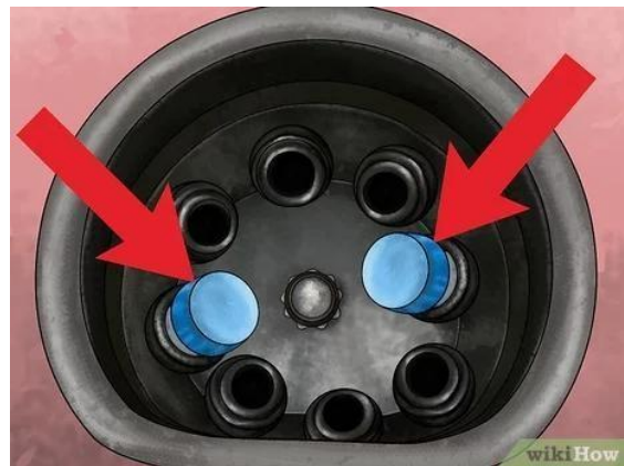
Figura 2: Referencia de como colocar los tubos de forma equilibrada.
