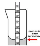
Figura 2: Lectura del menisco en la medición con densímetro.
