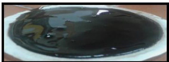
Figura 106. Fotos del revoque y filtrado obtenido en la prueba de filtración parte B: a) apariencia antes de lavar el revoque, b) apariencia después de lavar el revoque, c) grosor antes de lavar el revoque y d) grosor después de lavar el revoque.
