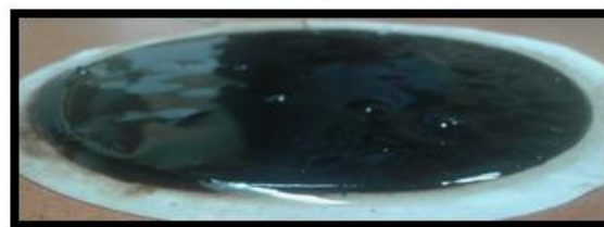
Figura 106. Fotos del revoque y filtrado obtenido en la prueba de filtración parte B: a) apariencia antes de lavar el revoque, b) apariencia después de lavar el revoque, c) grosor antes de lavar el revoque y d) grosor después de lavar el revoque.
