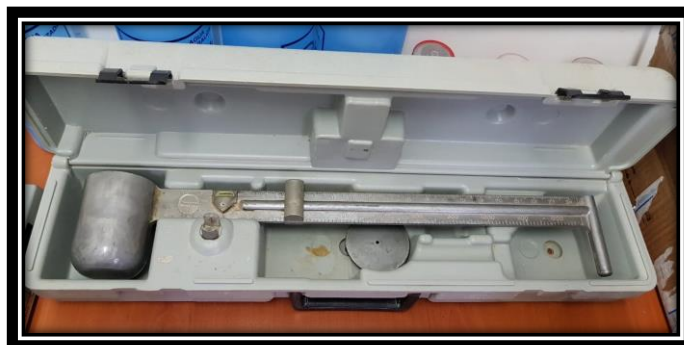
Figura 34. Balanza para densidad de lodos (Baroid). (Foto tomada del equipo)
