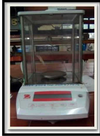
Figura 33. Balanza Analítica (HOAUS-PIONEER, modelo 214PCA). (Foto tomada del equipo)
