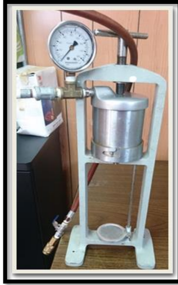
Figura 29. Filtro prensa API (presurizado básico, Fann, 207127, modelo 300). (foto tomada del equipo)
