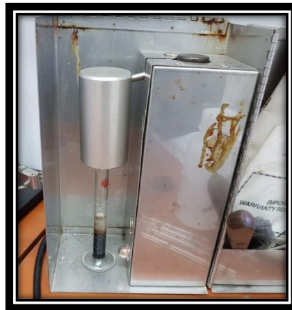
Figura 35. Kit de retorta 10 mL (Fann). (Foto tomada del equipo)
