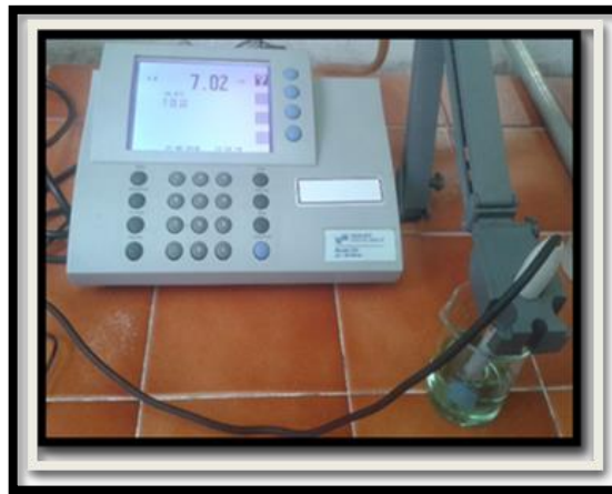
Figura 32. pH ISE meter (Denver Instrument, modelo225). (Foto tomada del equipo)
