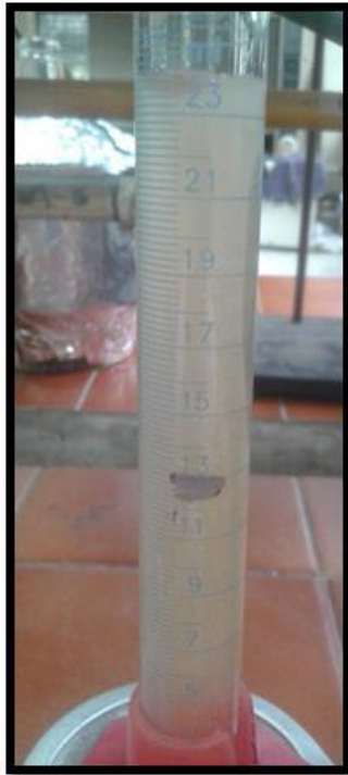
Figura 103. Fotos del revoque y filtrado obtenido en la prueba de filtración parte B: a) apariencia antes de lavar el revoque, b) apariencia después de lavar el revoque, c) grosor antes de lavar el revoque, d) grosor después de lavar el revoque y e) coloración del filtrado.
