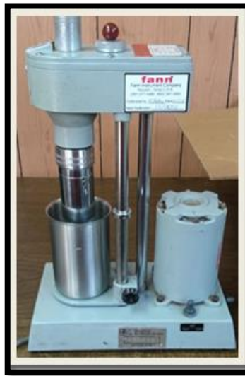
Figura 28. Viscosímetro de lectura directa (reómetro, Fann, 207198, modelo 35A). (foto tomada del equipo)
