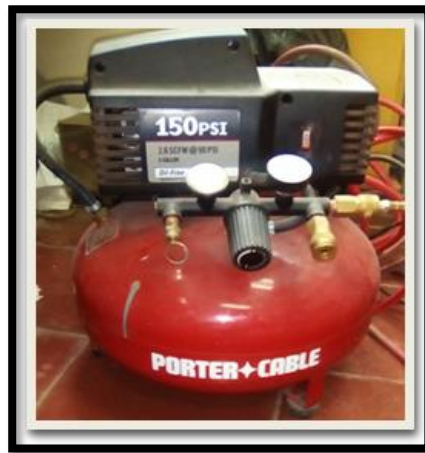
Figura 30. Compresor de aire con tanque plano. (PORTER-CABLE, modelo C2006). (Foto tomada del equipo)
