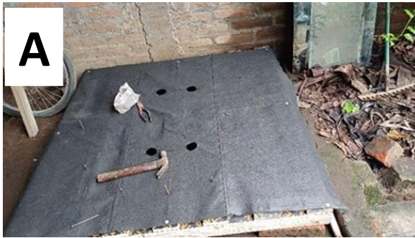
Figuras 5. Tarima en proceso de fabricación. A) Tarima con malla geotextil en medición. B) Tarima bajo estructura de biorreactor.
