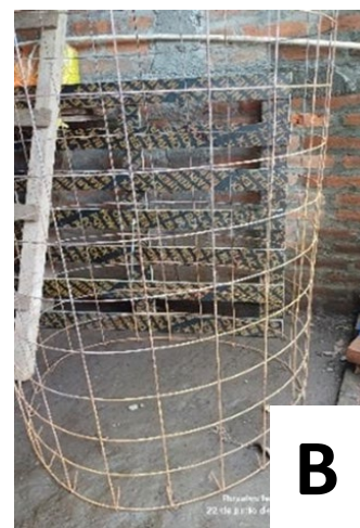
Figuras 6. Elaboración de cilindro compostero. A) Corte e electro malla. B) Armado de cilindro biorreactor en medida requerida.
